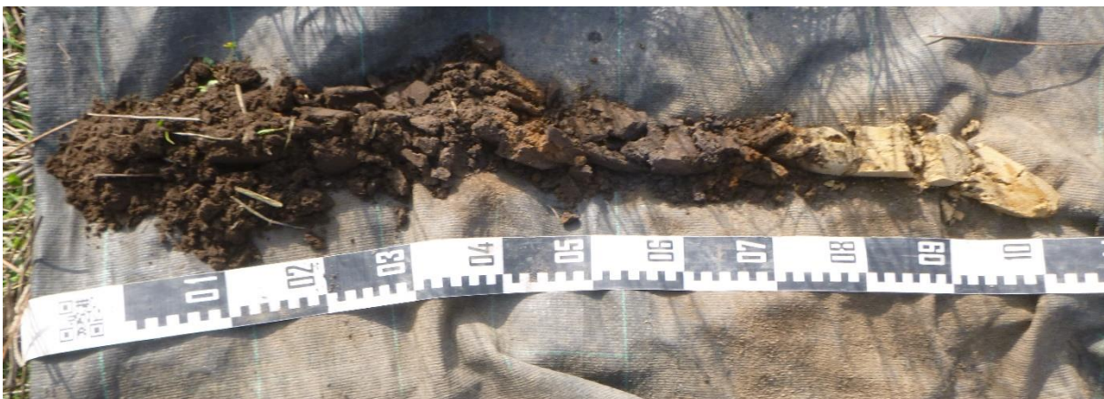
Figuur 21: Overzichtsfoto van boring BP5, uitgelegd van links naar rechts.
