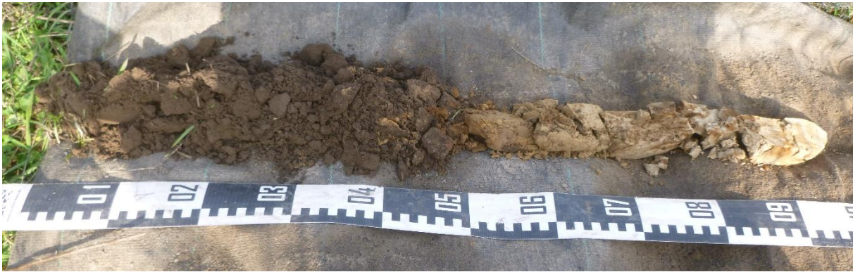
Figuur 14: Overzichtsfoto van boring BP8, uitgelegd van links naar rechts.
