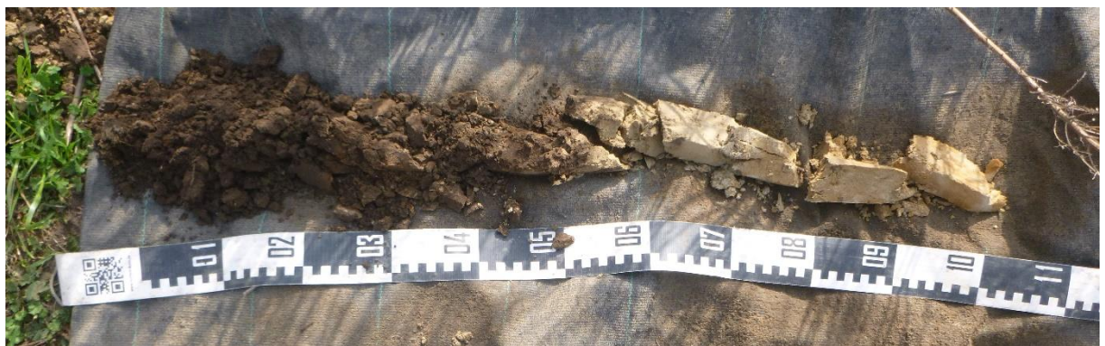
Figuur 13: Overzichtsfoto van boring BP1, uitgelegd van links naar rechts.
