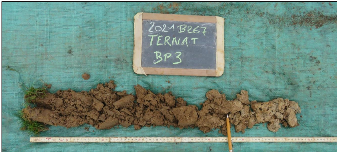
Figuur 7 Zicht op de boorkolom ter hoogte van boorpunt 3 met Ap – C profiel.
