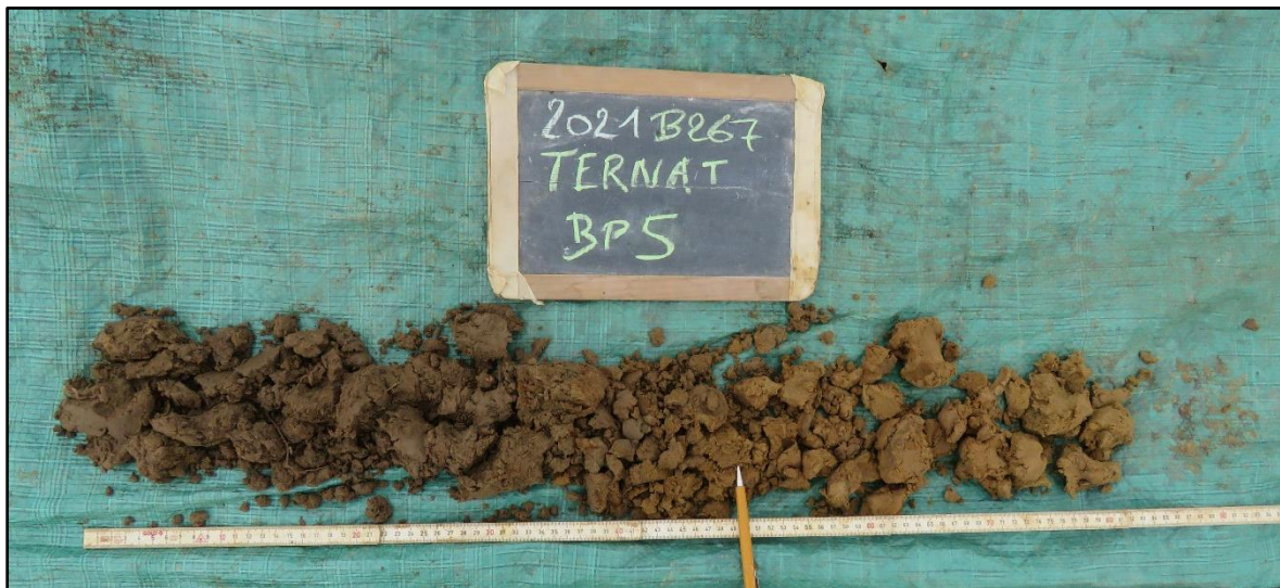
Figuur 8 Zicht op de boorkolom ter hoogte van boorpunt 5 met Ap – C profiel.
