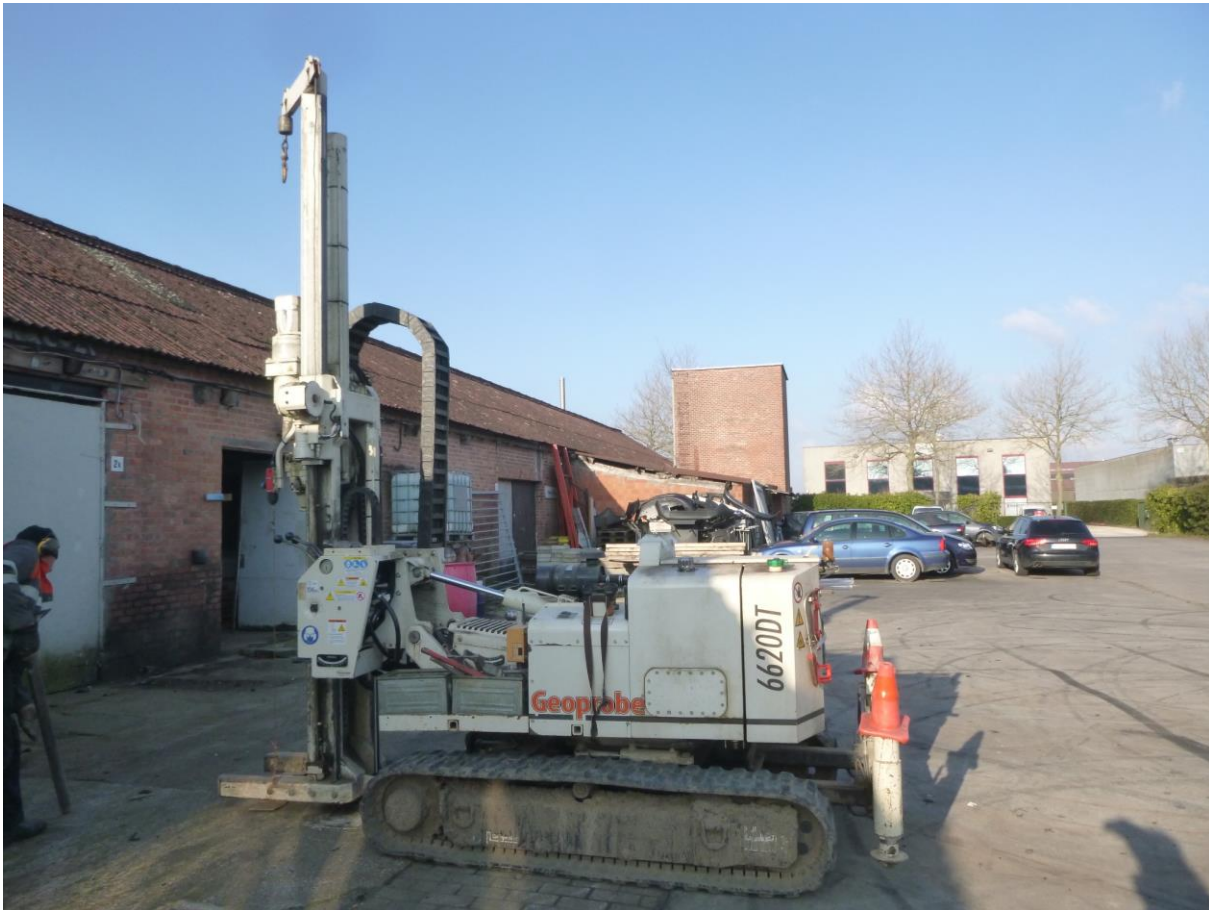
Figuur 3: Zijaanzicht van de Geoprobe boormachine, gebruikt tijdens dit bodemonderzoek.
