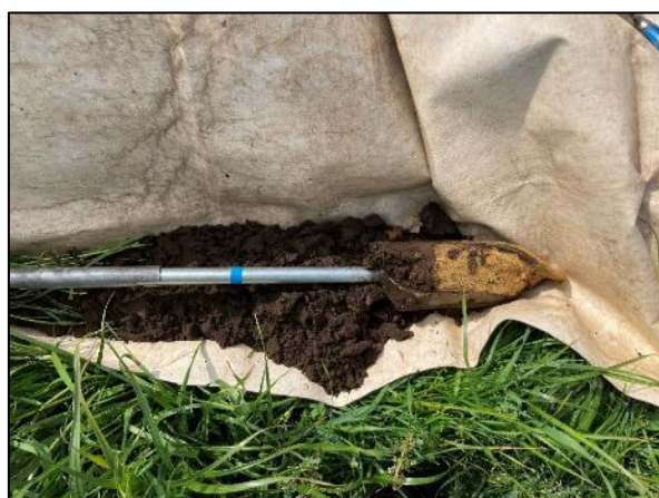
Figuur 5: Foto en boorstaat boring 1, referentiebooring voor een AC-sequentie (op de tweede foto valt de scherpe overgang in de boorkop op)
