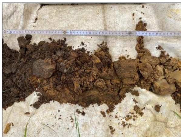
Figuur 6: Foto en boorstaat boring 4, referentieboring voor een A- verbrokkelde (E)B - C sequentie (op de tweede foto wordt een detail van de (E)B-horizont getoond)
