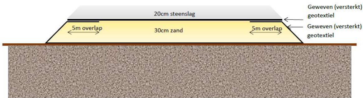
Figuur 10: Plan van de werkwijze in ophoging voor het terrein voor grondverbetering. (Bron: Opdrachtgever 2021).
