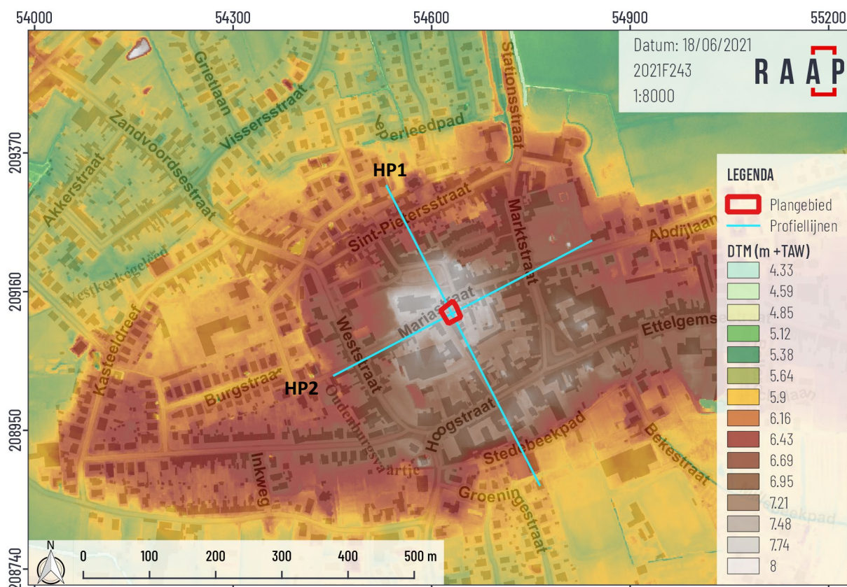
Figuur 14. Digitaal Terreinmodel Vlaanderen (detail) geprojecteerd op een recente orthofoto (2017) met projectie van het plangebied en aanduiding van de hoogteprofielen (bron: AGIV, 2015a; VMM, 2021).
