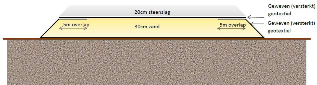
Figuur 7: Werken binnen het terrein voor grondverbetering (Initiatiefnemer 2021).
