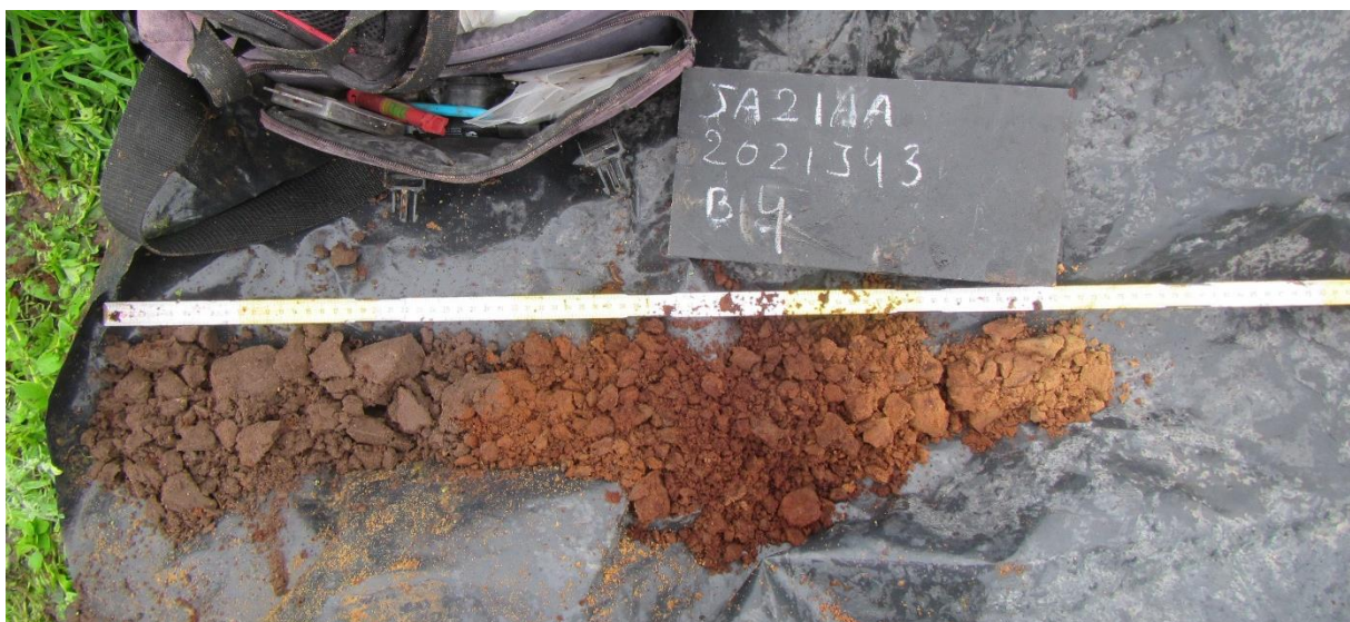
Figuur 30: Boring 4 (B4), voorbeeld van een boring met een laag die wijst op een waterhoudende structuur
