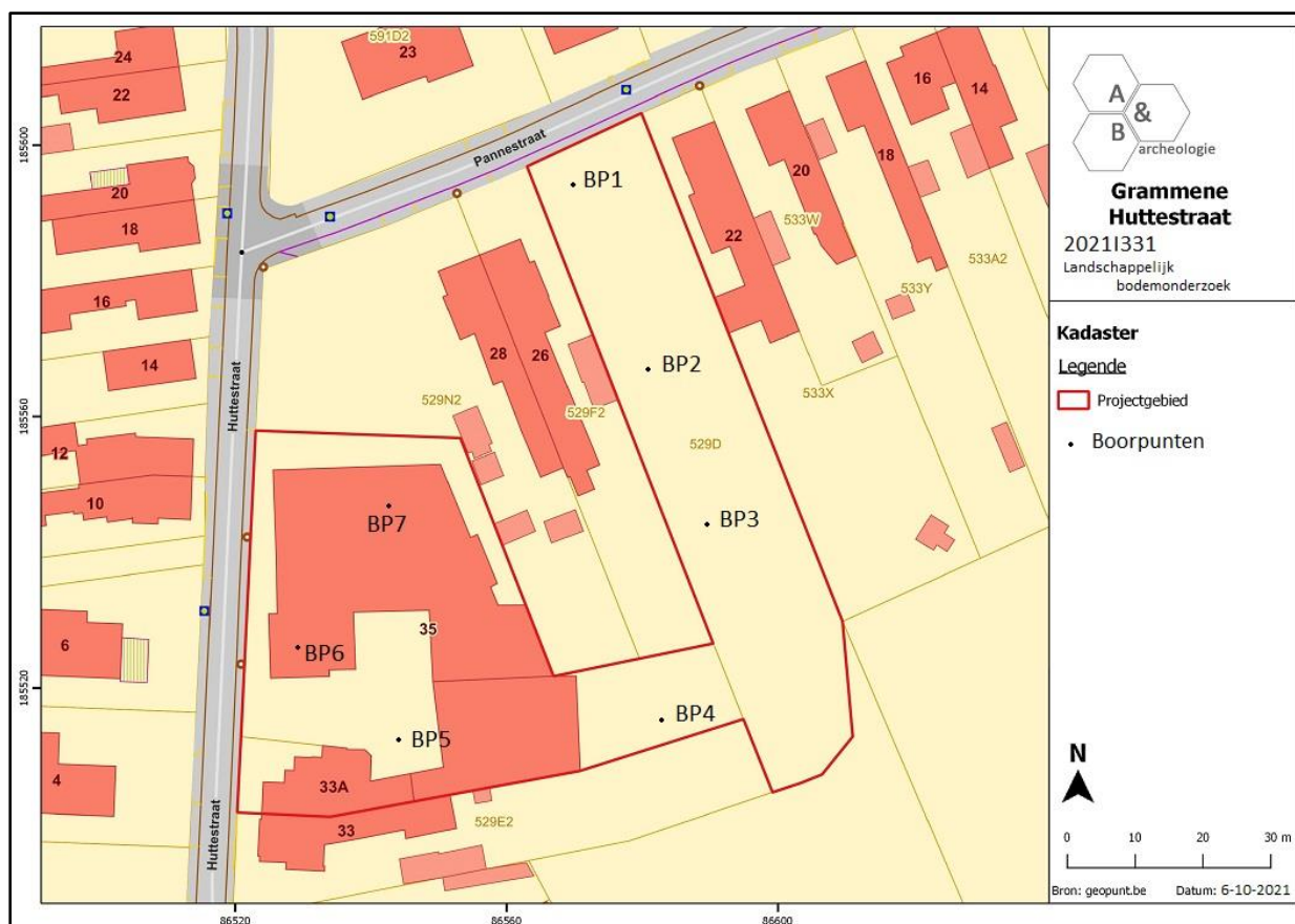
Figuur 5 Aanduiding van de effectief uitgevoerde boorpunten van het landschappelijk bodemonderzoek op het kadaster (bron: geopunt).
