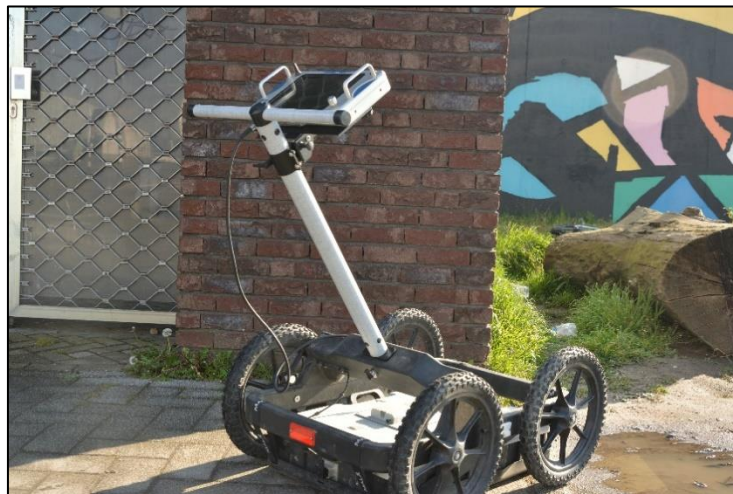
Figuur 48: Foto van de opstelling van de grondradar op het terrein.
