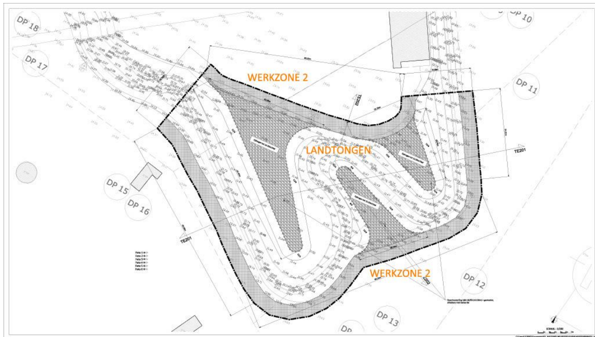
Figuur 12. Plan met aanduiding van de aanleg van de landtongen in het verbreed gedeelte van de Gaverbeek (bron: opdrachtgever)
