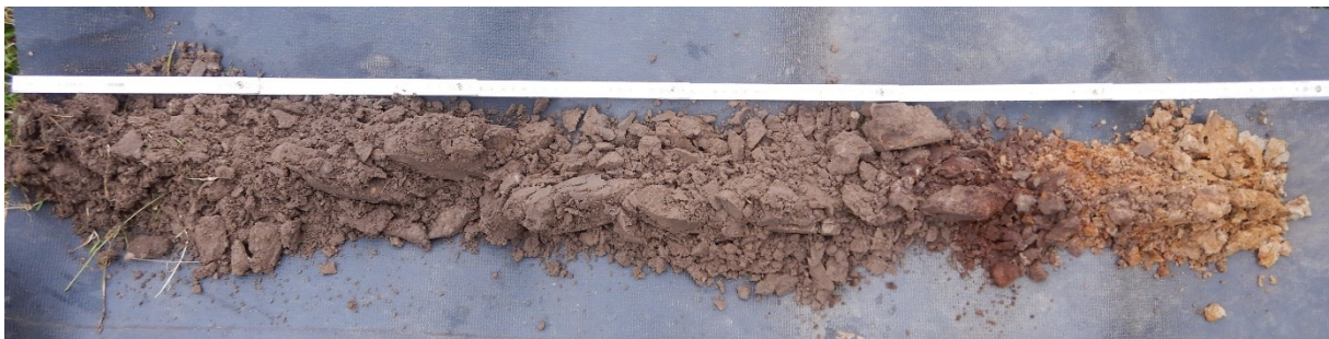
Figuur 4. Boorprofiel van boorpunt 2.
