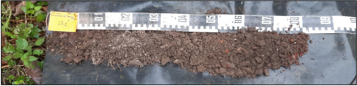
Figuur 7: Boring 1a, gestuit op 80 cm onder het maaiveld.
