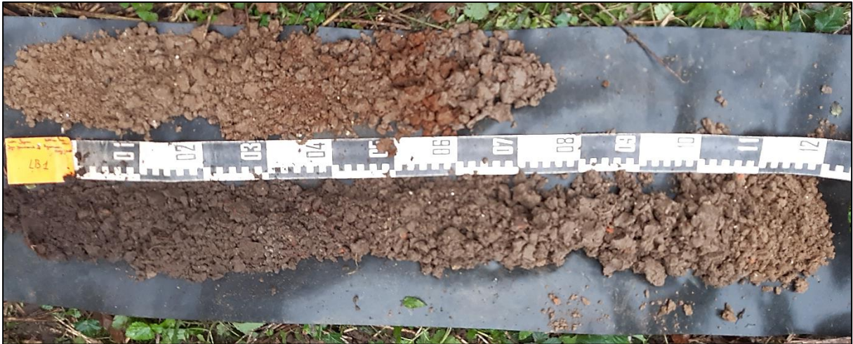
Figuur 8: Boring 1b, van 0 cm (linksonder) tot 190 cm (rechtsboven) onder het maaiveld.
