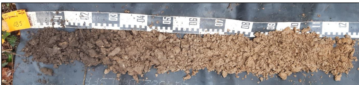
Figuur 13: Boring 5, van 0 cm (links) tot 120 cm (rechts) onder het maaiveld.
