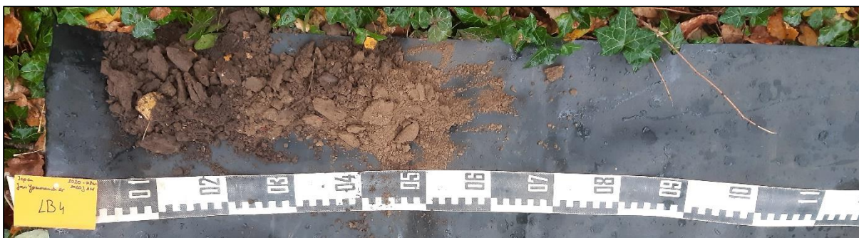
Figuur 11: Boring 4a, gestuit op 50 cm onder het maaiveld.
