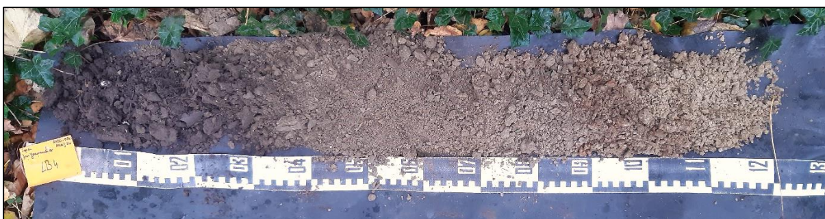
Figuur 12: Boring 4b, van 0 cm (links) tot 120 cm (rechts), onder het maaiveld.
