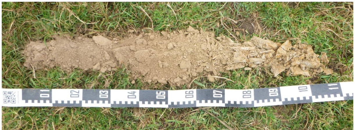
Figuur 11: Overzichtsfoto van boring BP4, uitgelegd van links naar rechts.
