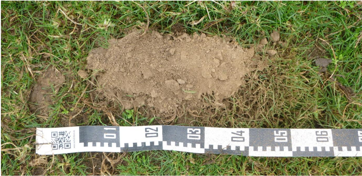
Figuur 12: Overzichtsfoto van boring BP5, uitgelegd van links naar rechts.
