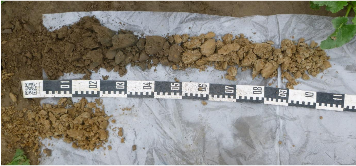
Figuur 8: Overzichtsfoto van boring BP1, uitgelegd van links naar rechts en van boven naar onder.
