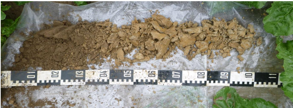
Figuur 9: Overzichtsfoto van boring BP2, uitgelegd van links naar rechts.
