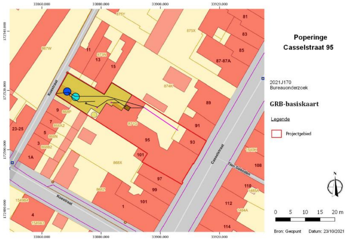
Figuur 14 Vereenvoudigde weergave van de geplande werken. Legende.: Geel: nieuwbouw, blauw: regenwaterput, lichtblauw: infiltratieput, bruin: vetvanger, zwart: riolering, paars: bestaande riolering en afvoerputjes (bron: geopunt)
