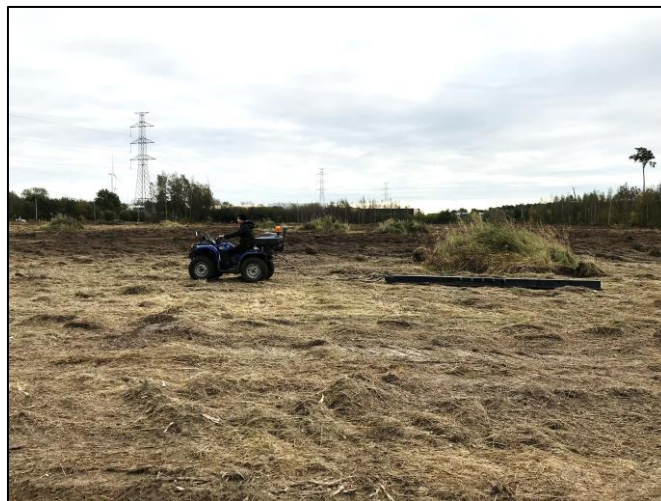
Figuur 4: Mobiele sensorconfiguratie met de EMI sensor in de slede en RTK-GPS.
