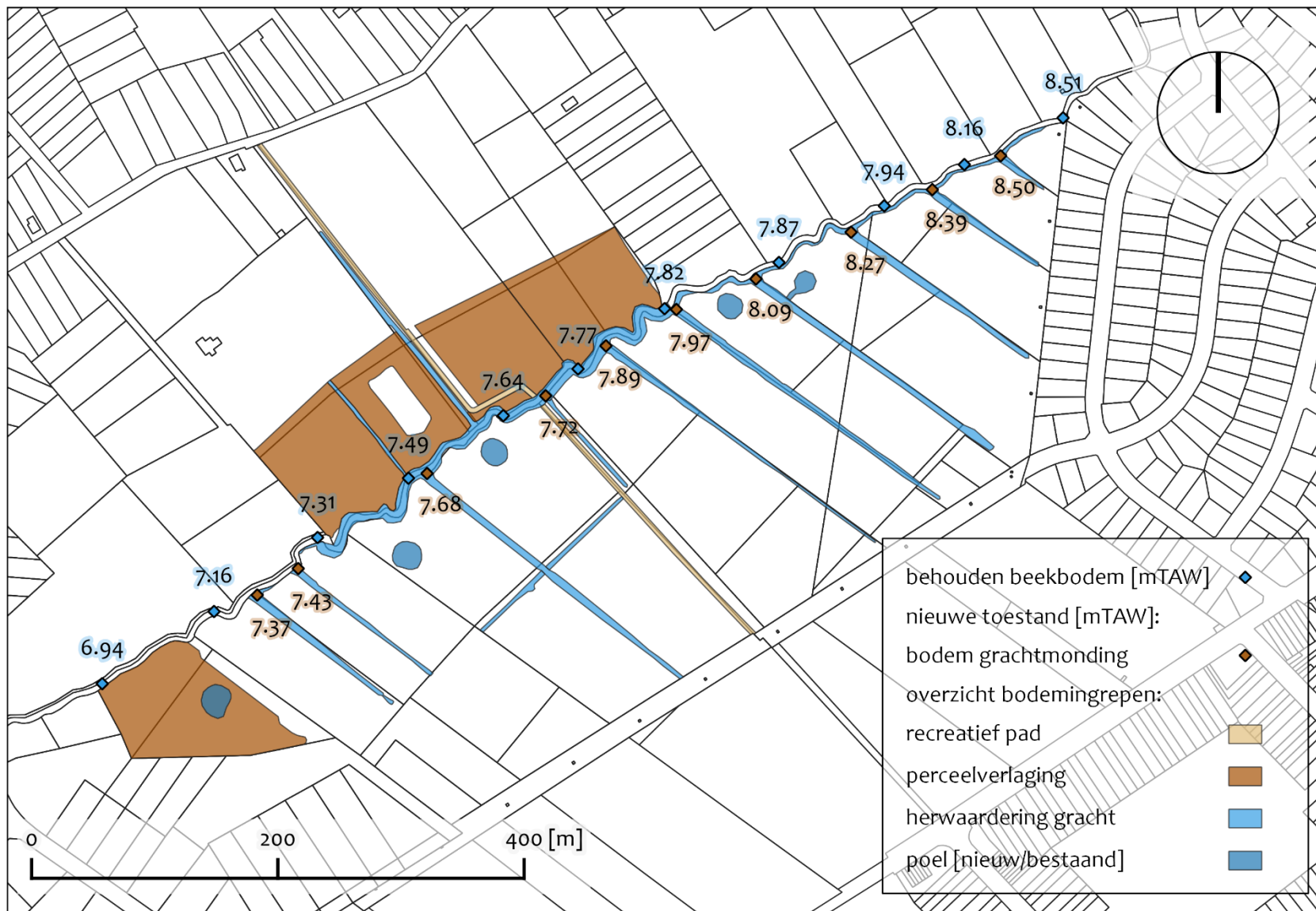
Figuur 6: Vereenvoudigde weergave ontwerpplan t.a.v. actueel kadaster en met vergelijking tussen de hoogteligging van de te behouden beekbodem van de Kaartse Beek en de nieuwe grachtmondingen [© geopunt; AIV]
