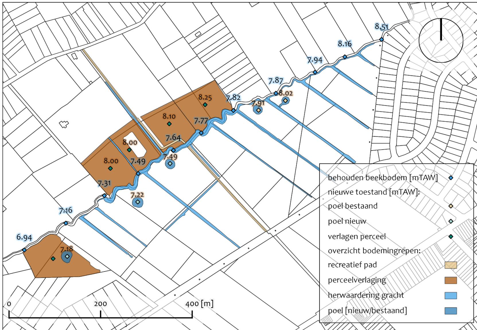
Figuur 7: Vereenvoudigde weergave ontwerpplan t.a.v. actueel kadaster en met vergelijking van de hoogteligging van de te behouden beekbodem van de Kaartse Beek en de omliggende perceelverlaging en poelen [© geopunt; AIV]
