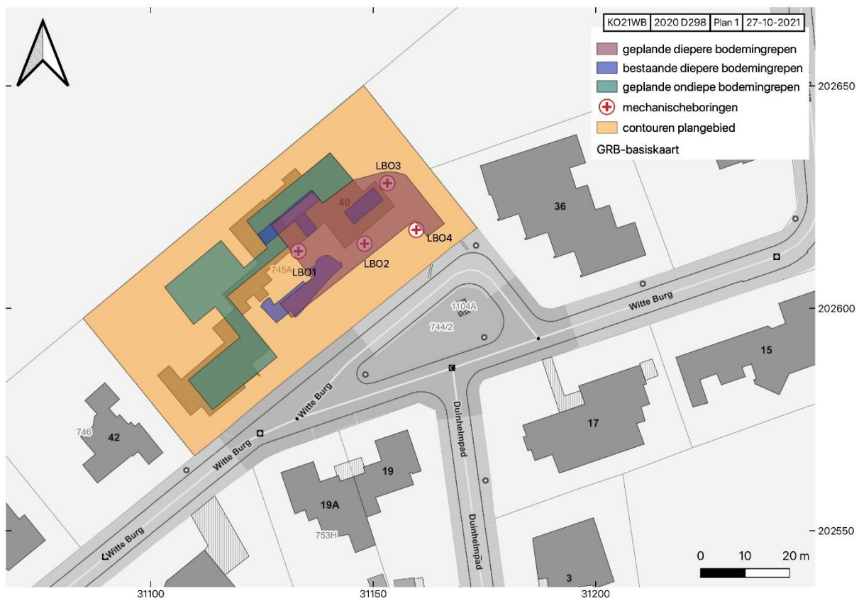
Figuur 1/Plan 1: syntheseplan met aanduiding van de uitgevoerde LBO's tov het GRB
