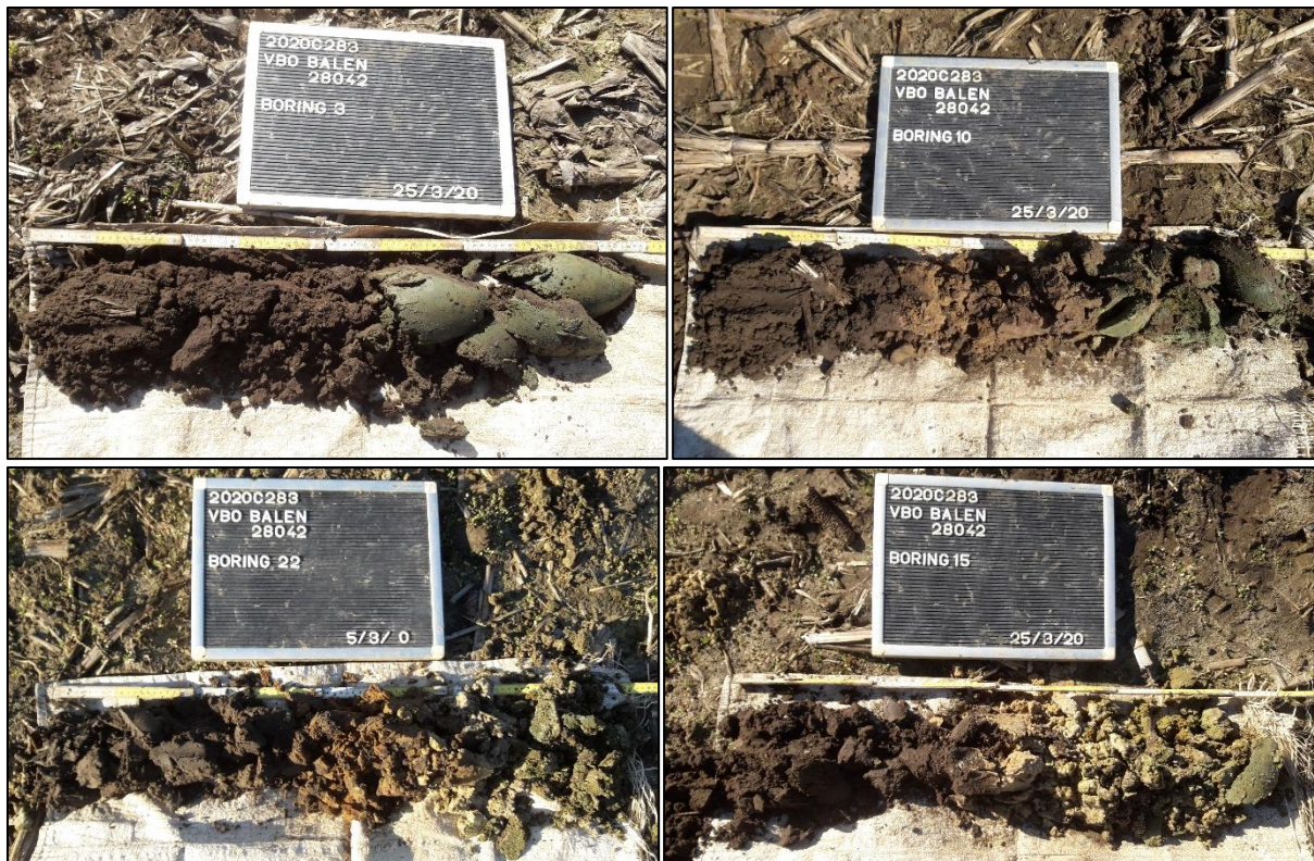
Figuur 8: Boorprofielen ter illustratie van de aangetroffen bodemopbouw: boring 3 (linksboven; Ap-tertiair), boring 10 (rechtsboven; Ap-Bh-tertiair), boring 22 (linksonder; Ap-Bh-C-tertiair) en boring 15 (rechtsonders; Ap-C-tertiair) (ABO nv 2020)
