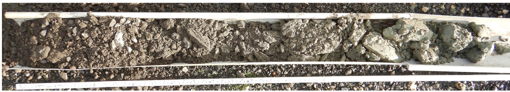
Figuur 26. Controleboring 2. Door de lage zonnestand zijn de kleuren van het sediment grijzer dan in realiteit.
