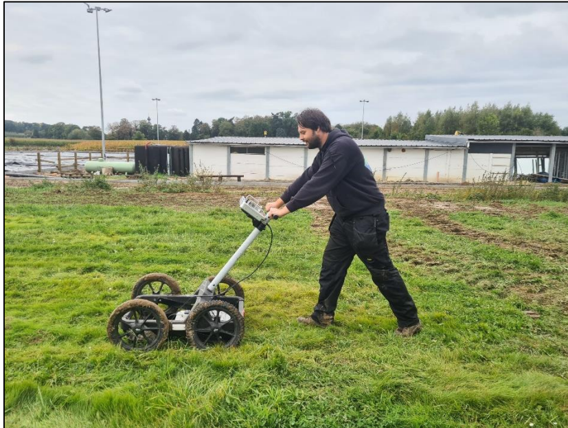
Figuur 62: Terreinfoto met GPR-opstelling.
