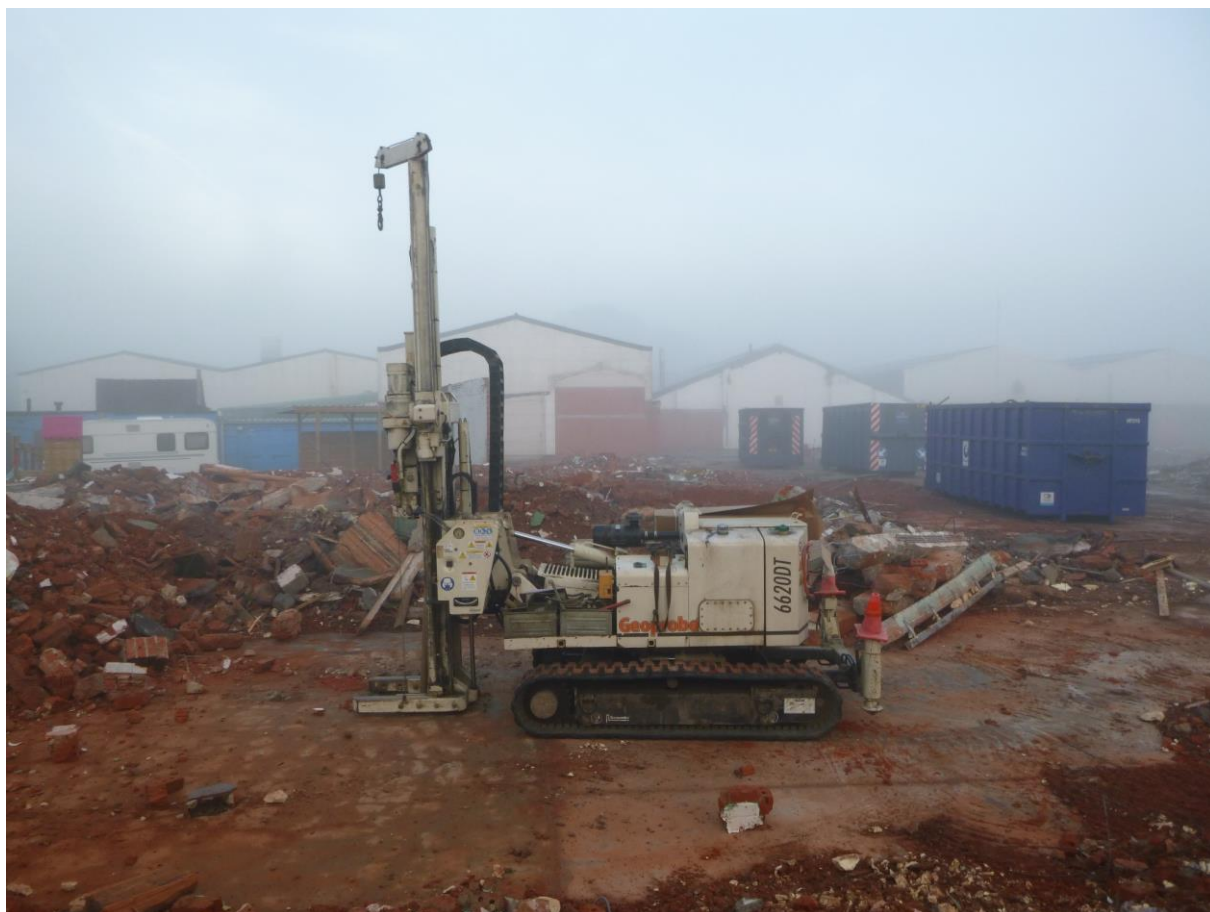
Figuur 3: Zijaanzicht van de Geoprobe in actie tijdens dit booronderzoek.
