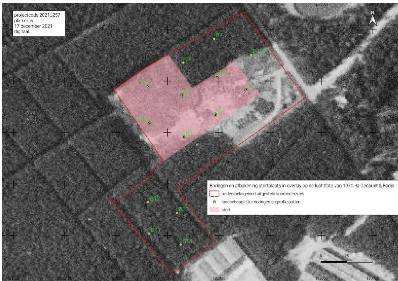
Fig. 6 Boringen en afbakening stortplaats in overlay op de orthofotomosaïek kleinschalig zomer van 1971. © Geopunt & Fodio
