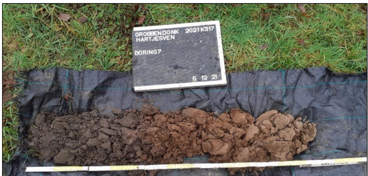
Figuur 57: Boringen 2 en 7 als voorbeelden van A-B-C sequenties
