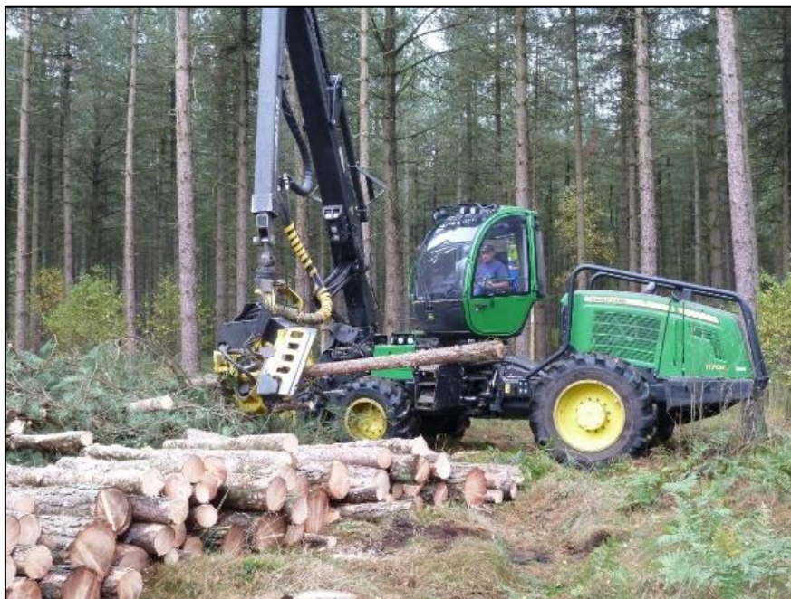
Figuur 8: Harvester, in te zetten voor het vellen en de eerste verwerking van de boomstammen (Initiatiefnemer 2021)
