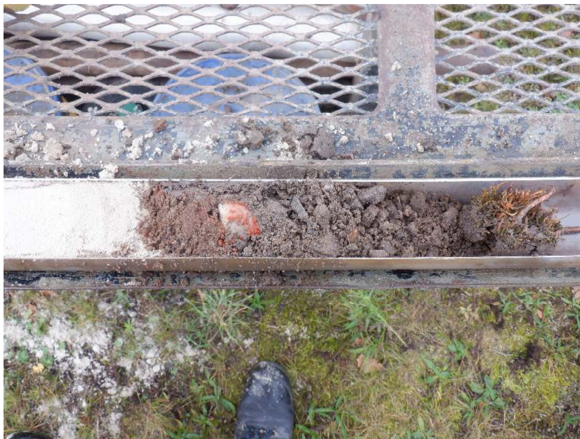
Afbeelding 4.1: Detail van de bouwvoor/geroerde laag in boring 21.
