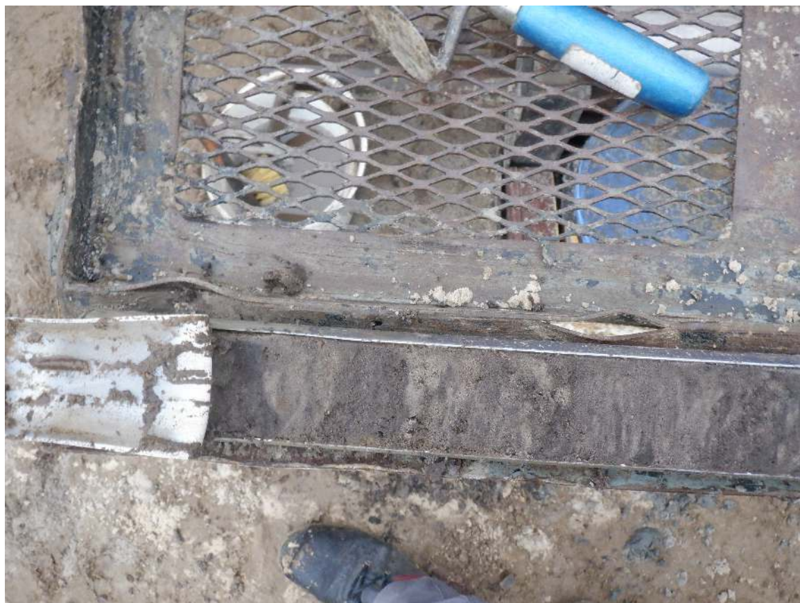
Afbeelding 4.7: heterogene geroerde laag in het onderste van boring 11.
