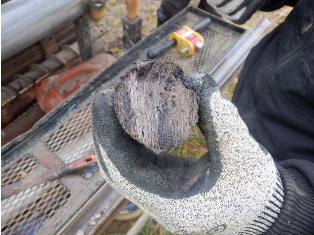
Afbeelding 3.6.4: Boring 23 werd gestaakt op een boomstam die in het moeras lag.
