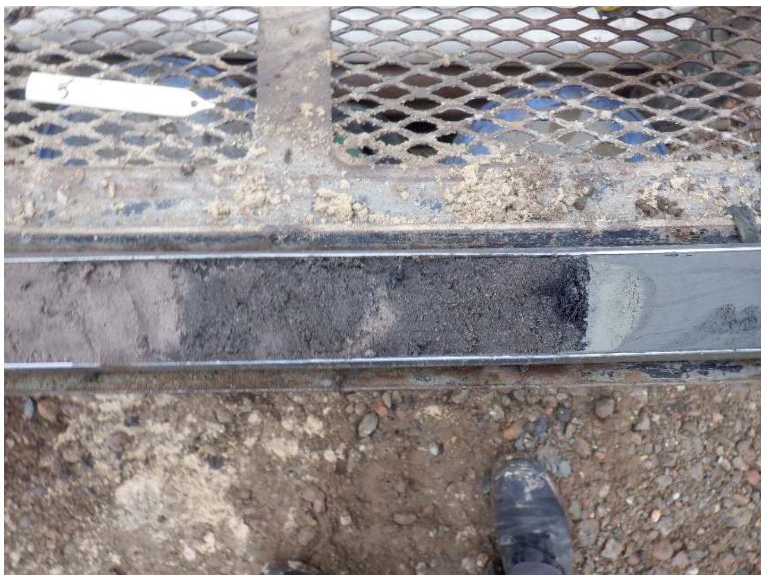
Afbeelding 4.10: Detail van de Abb-horizont in boring 5. De bovenzijde is afgetopt. De overgang naar een ophoging waarbij klei gebruikt werd is zeer scherp en dwars doorheen een brok met iets moeriger materiaal.
