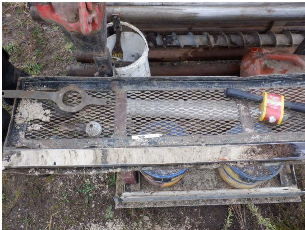
Afbeelding 4.2: Geroerde laag in de bovenste liner (tot 1,5 m -Mv) van boring 20.
