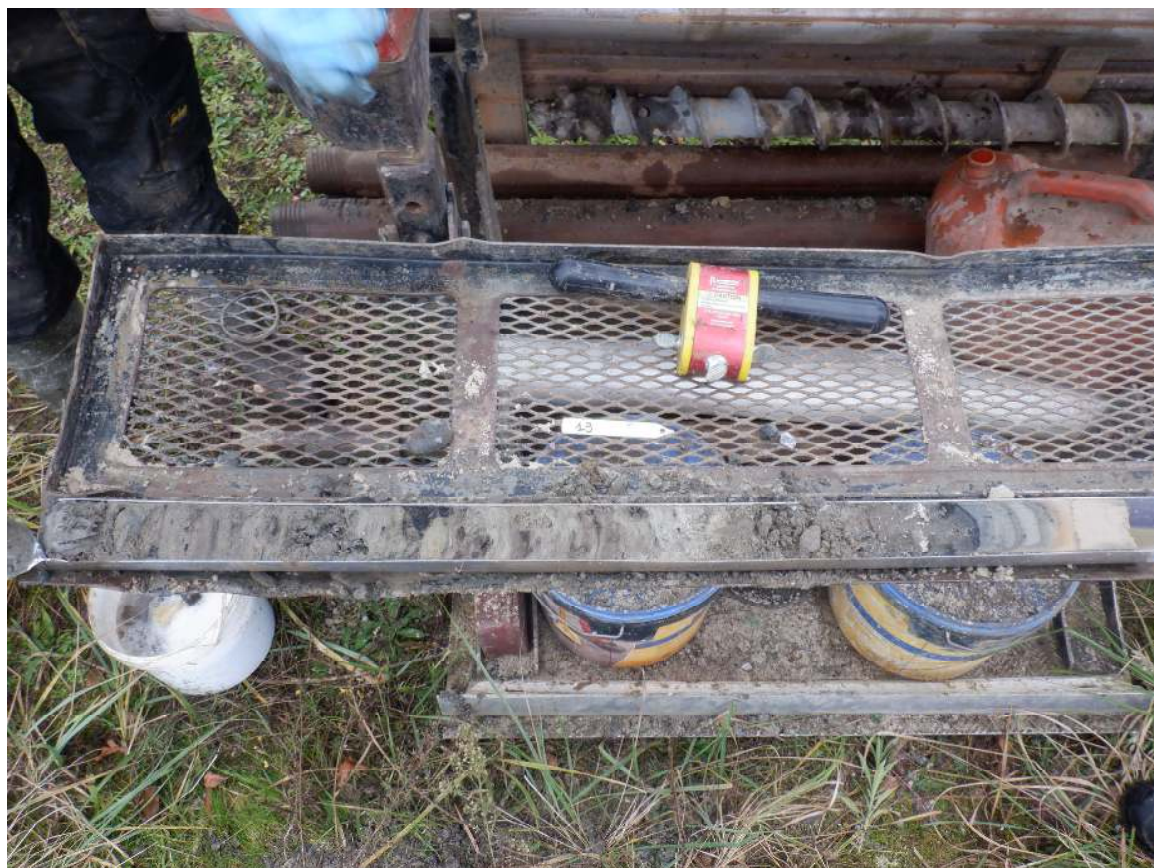
Afbeelding 4.4: Detail van de sterk geromelde laag in de tweede liner (1.5 - 3 m -Mv) van boring 19.
