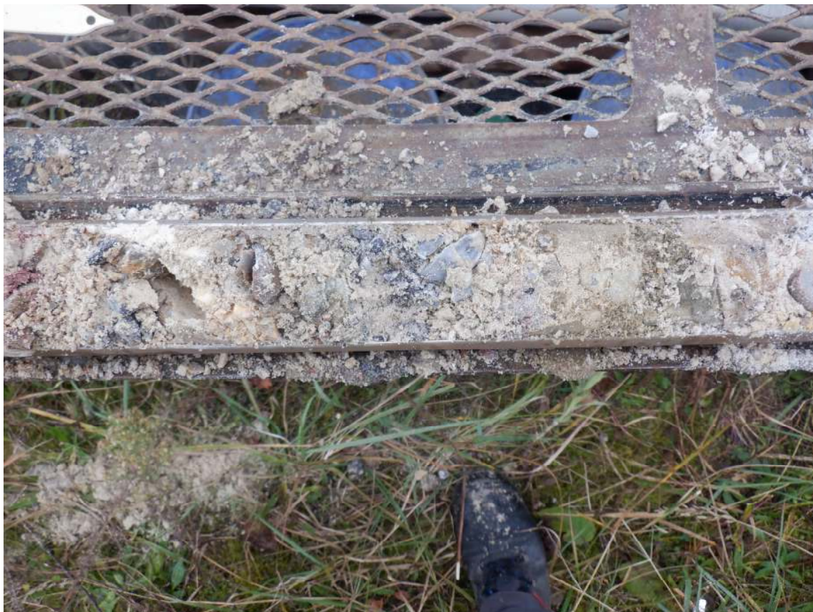
Afbeelding 4.3: Detail van een keirijke laag in het geroerde pakket van boring 19.
