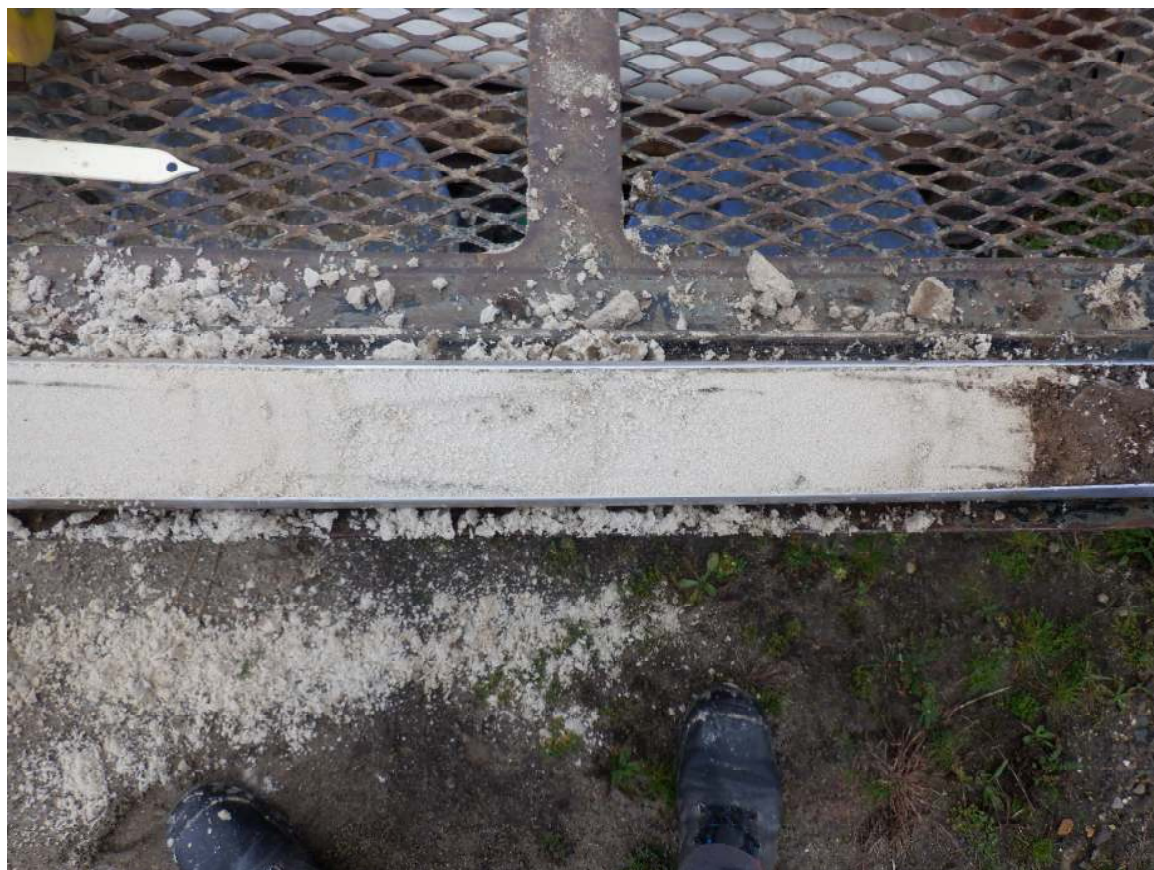
Afbeelding 4.5: Zeer homogeen ophoogpakket in boring 14.
