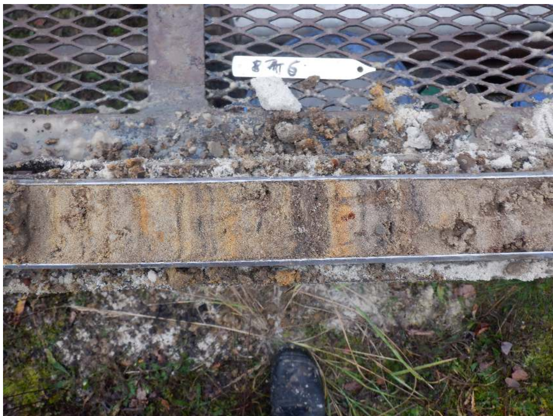
Afbeelding 4.9: Heterogeen ophoogpakket in boring 6.
