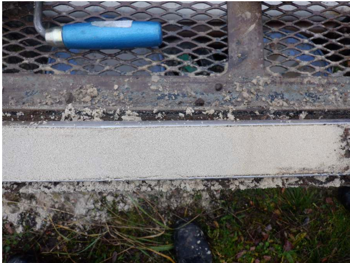
Afbeelding 4.8: Zeer zuivere homogeen ophoogpakket met alluviaal zand in boring 6.
