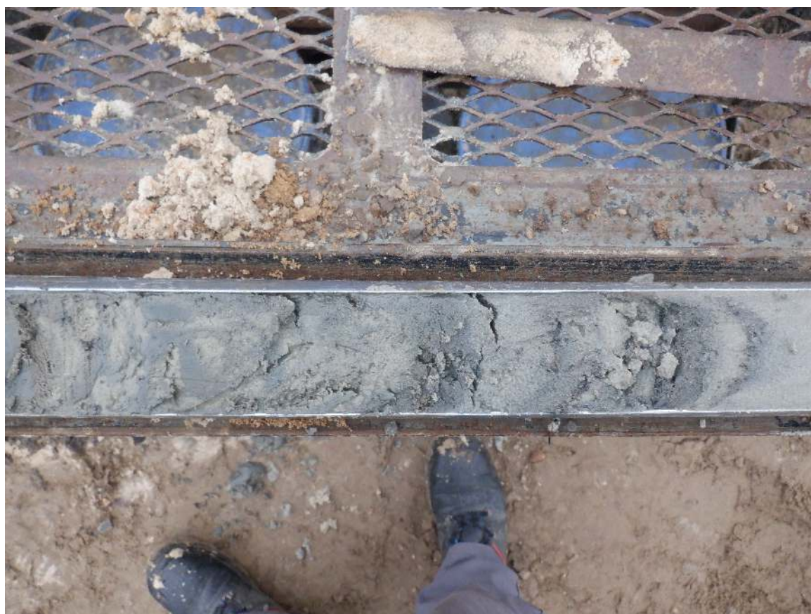
Afbeelding 4.6: Zeer heterogeen ophoogpakket met brokken klei in boring 11.
