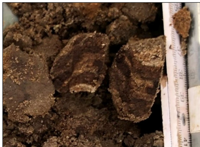
Figuur 14: Venig laagje in boring B4
