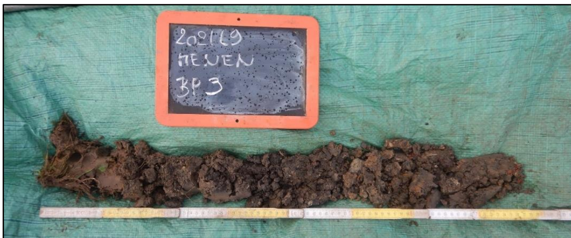
Figuur 7 Zicht op de boorkolom ter hoogte van boorpunt 3 met verstoorde lagen. De boring werd gestaakt door grof puin.
