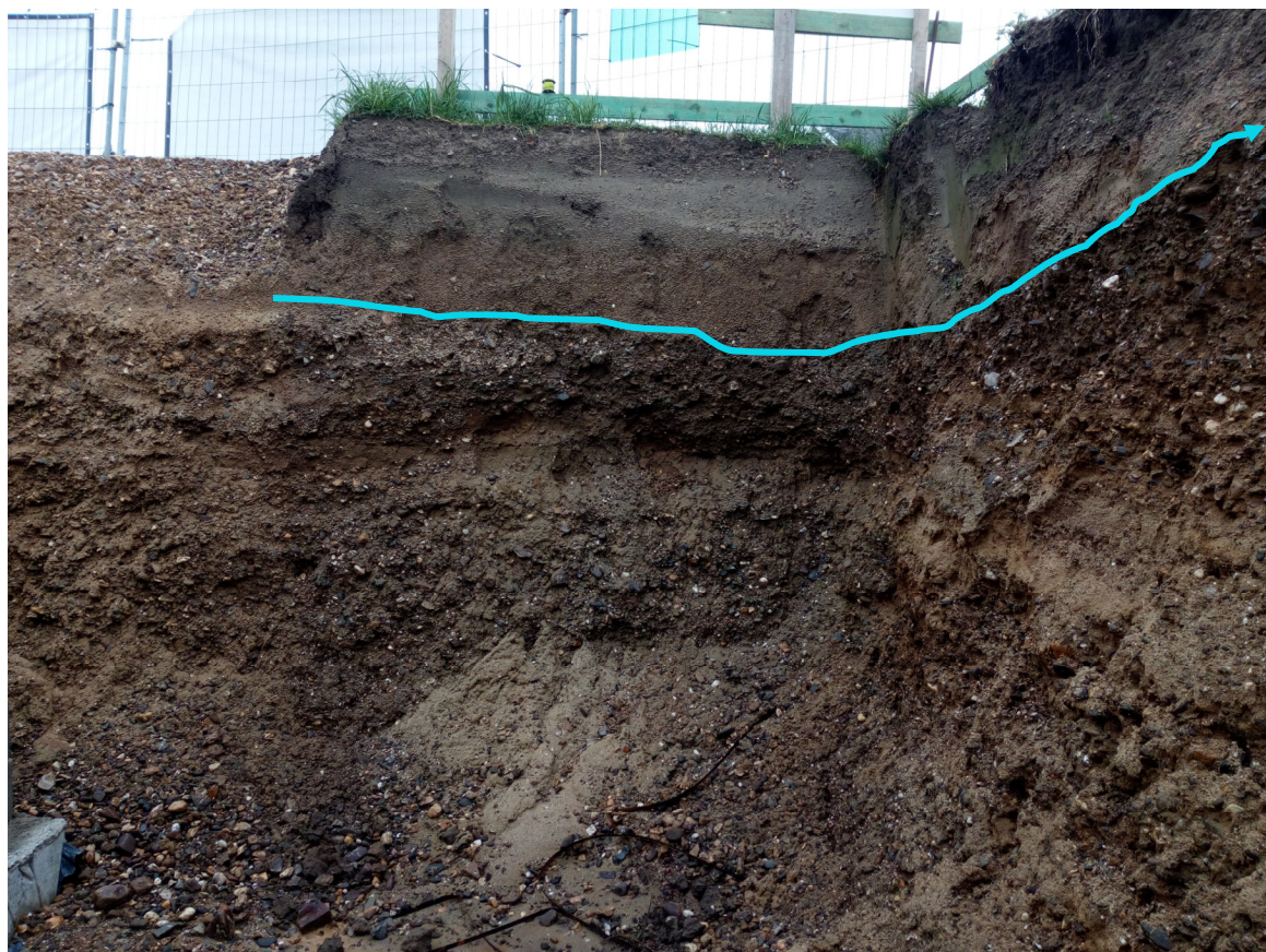
Afbeelding 4.2.11: Impressie van het bodemprofiel met de diverse grinden en grove zanden als bovenliggend alluvium.
