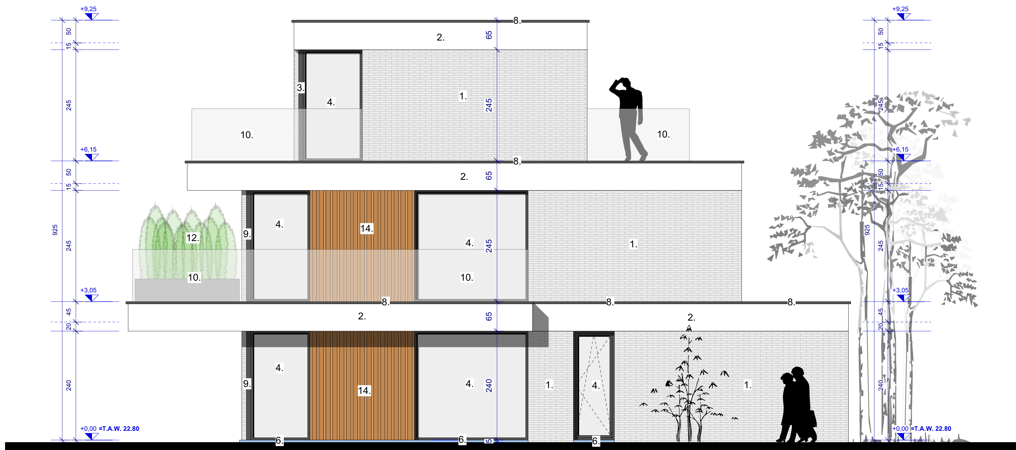
RECHTERZIJAANZICHT - BLOK A - SCHAAAL 1/50
