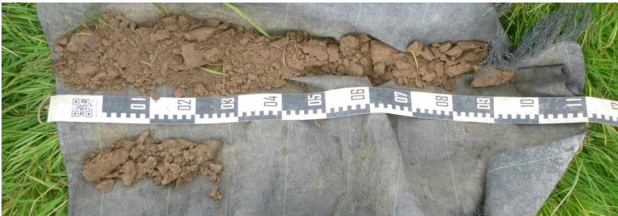
Figuur 11: Overzichtsfoto van boring BP6, uitgelegd van links naar rechts en van boven naar onder.
