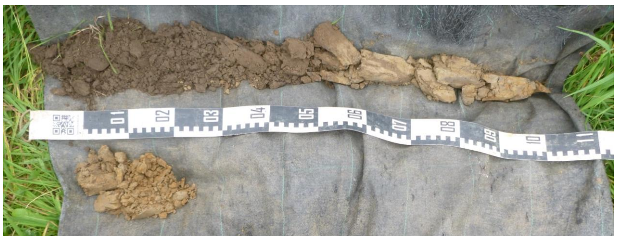
Figuur 13: Overzichtsfoto van boring BP7, uitgelegd van links naar rechts en van boven naar onder.
