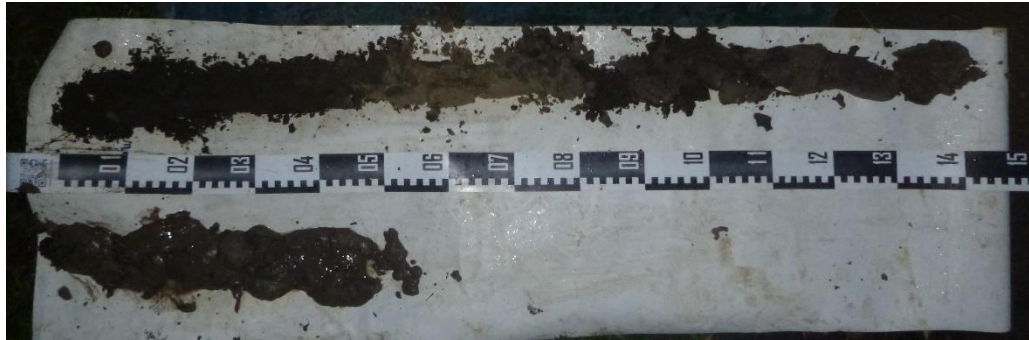
Figuur 42: Overzichtsfoto van boring BP4. Deze boring is, in tegenstelling tot de andere boringen, manueel uitgevoerd.
