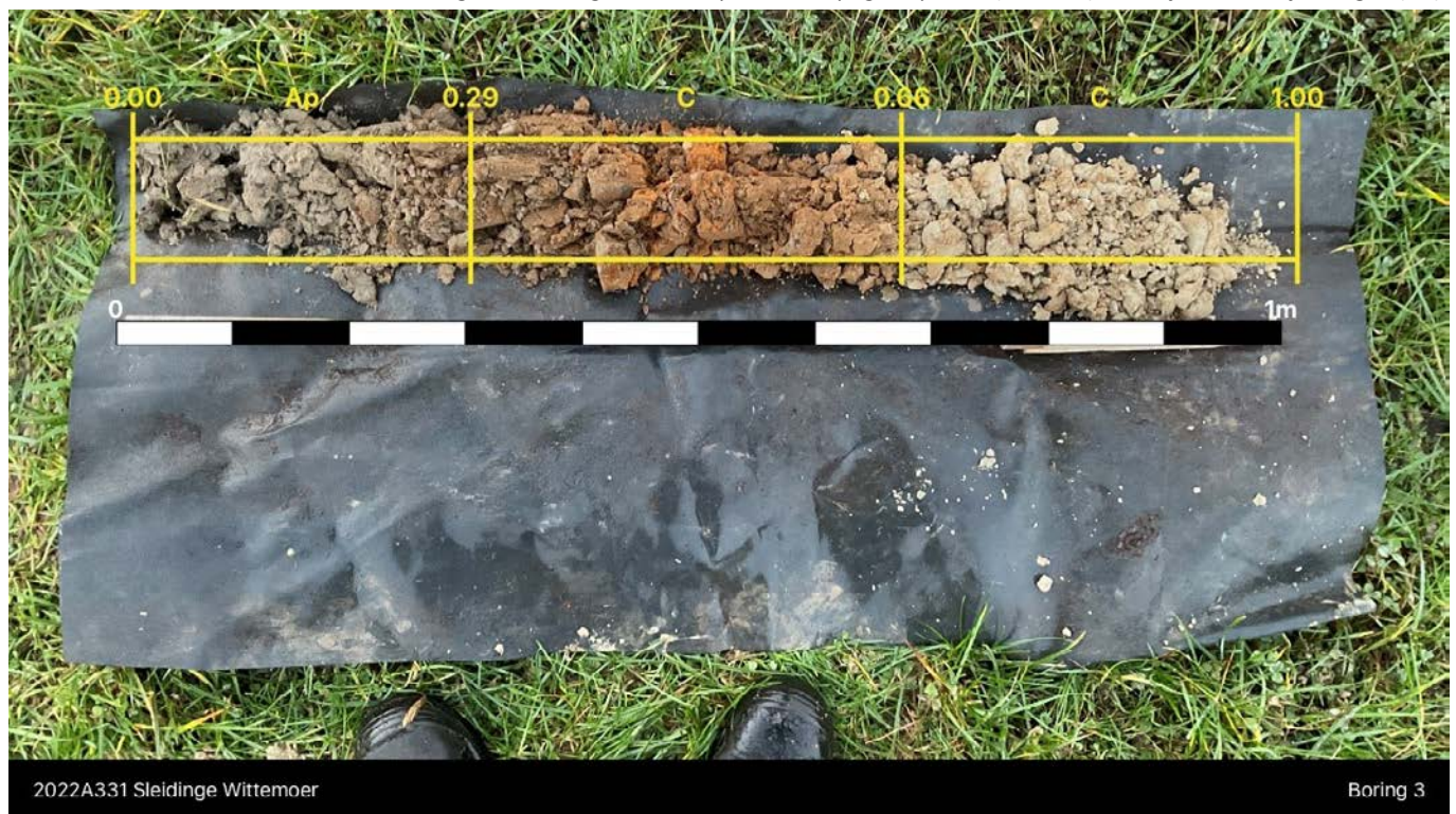
Figuur 10: Boring 8 met onder de ploeglaag een structuur B-horizont.
