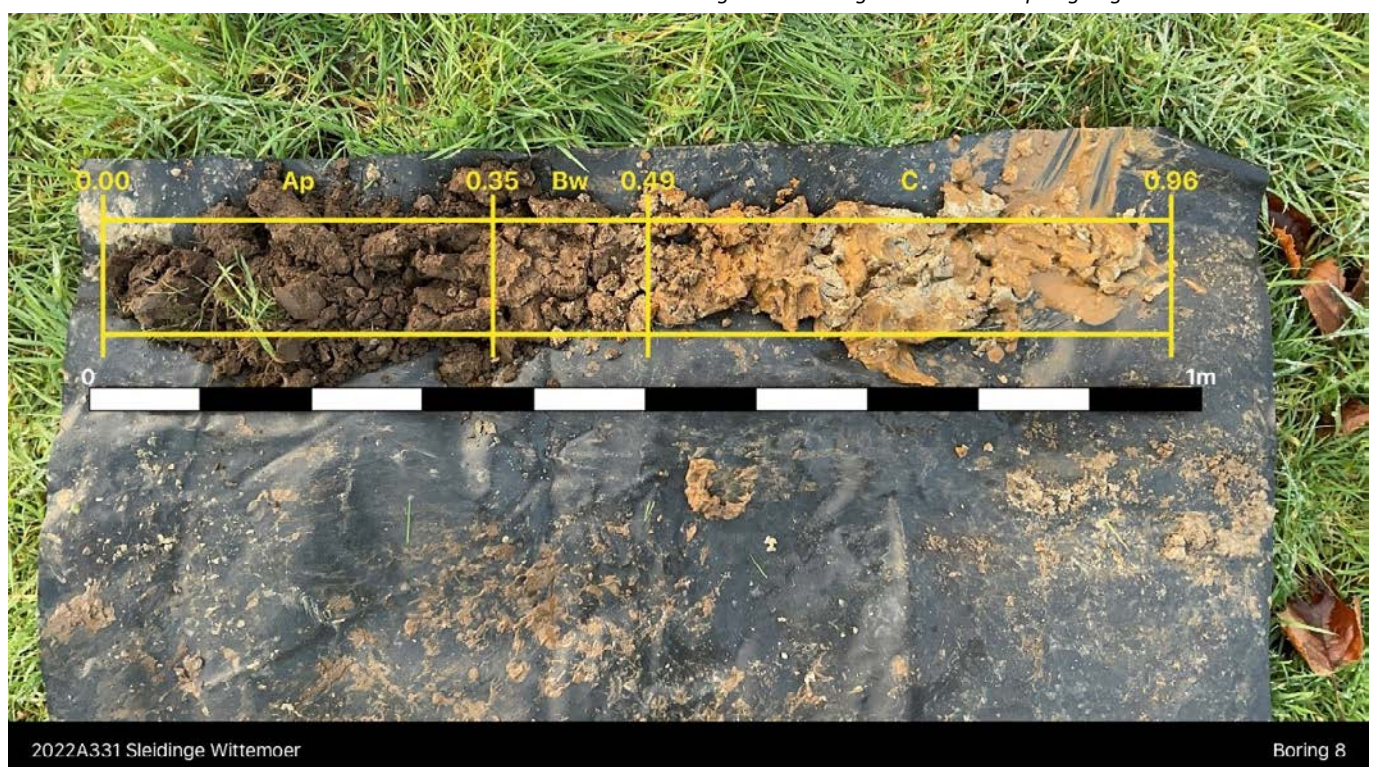
Figuur 10: Boring 8 met onder de ploeglaag een structuur B-horizont.
