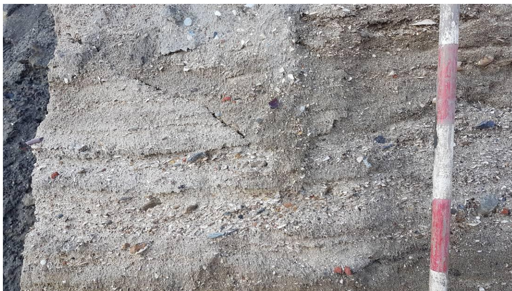
Afb. 22. Detail wandprofiel nabij boring 13 (detail afb. 19 links boven) met een sedimentair gelaagd zandpakket met schelpfragmenten en stukjes rode baksteen . Opnamedatum: 20-01-01-2022.
