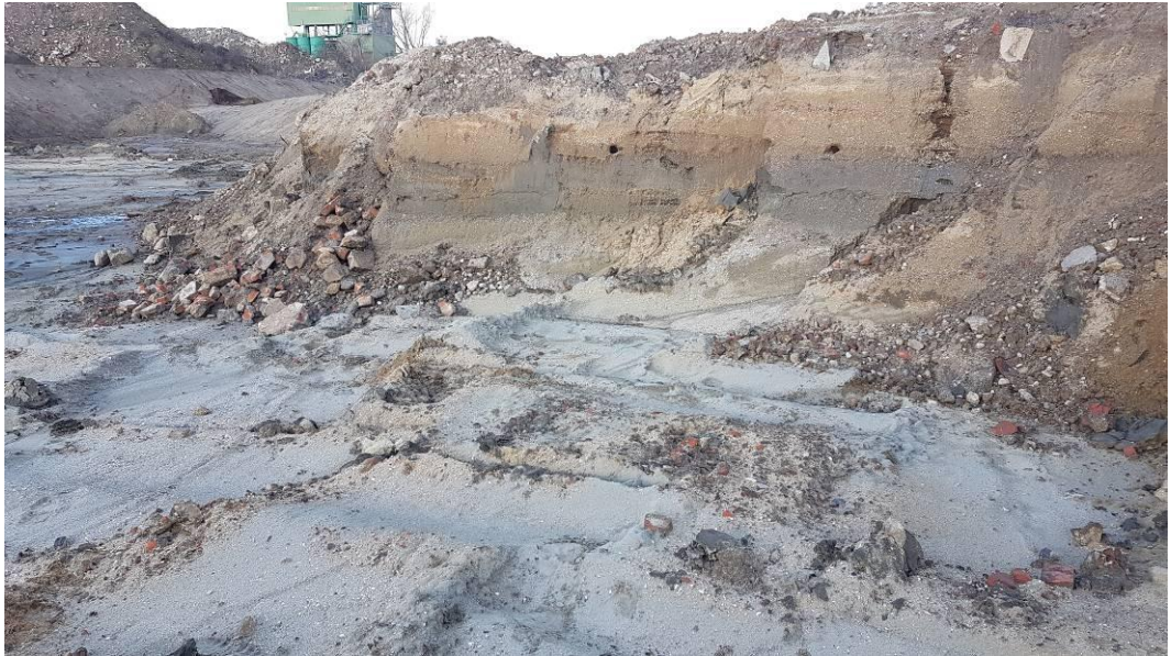
Afb. 20. Wandprofiel nabij boring 23 (basis op circa 7 m +TAW) met een massieve kleilaag tussen twee zandeenheden. Opnamedatum: 20-01-01-2022.
