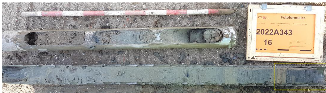
Afb. 33. Foto van boring 16, uitgelegd van links boven naar rechts onder. Kader basis profiel betreft detail afbeelding 32.
