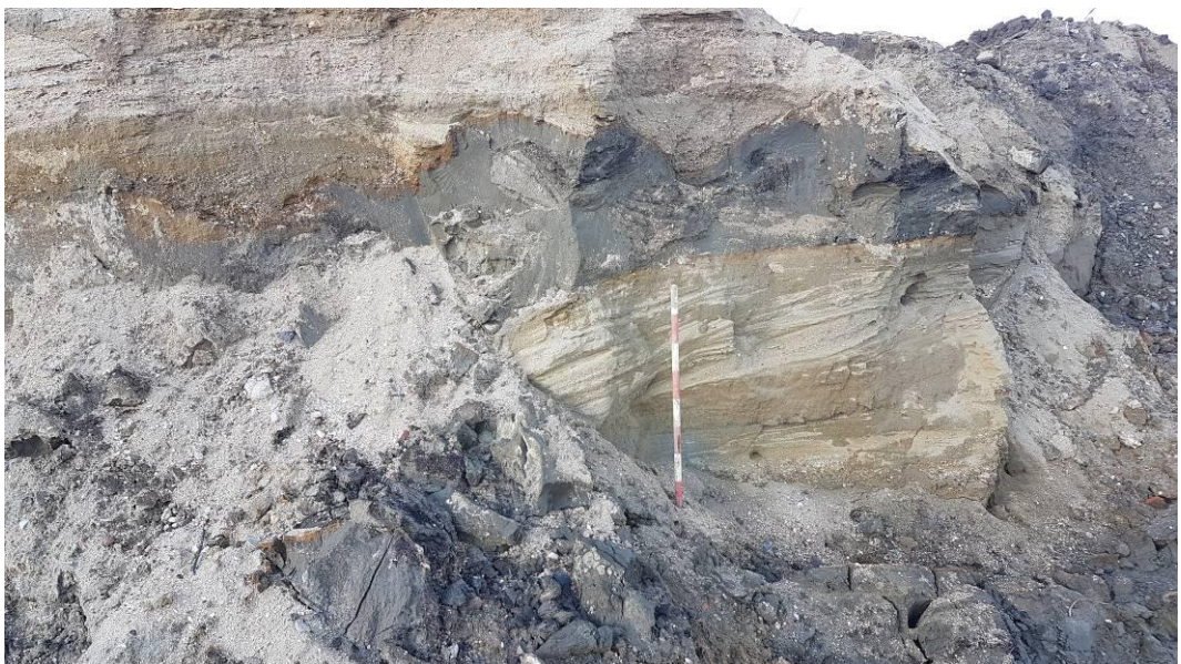
Afb. 21. Wandprofiel nabij boring 13 (basis op circa 7 m +TAW) met een massieve kleilaag tussen twee zandeenheden, elk met een duidelijke sedimentaire (kraskras) gelaagheid. De top van de kleilaag lijkt geërodeerd. Opnamedatum: 20-01-01-2022.
