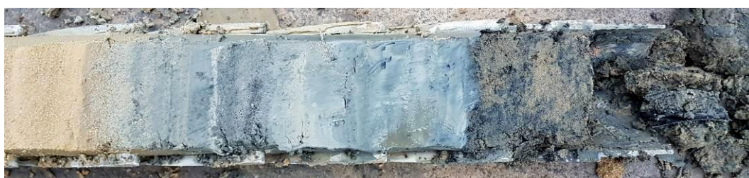
Afb. 26. Detailfoto van de basis van boring 7, uitgelegd van links naar rechts met de abrupte overgang van kalkrijke zware klei naar kalkloos fijn zand.
