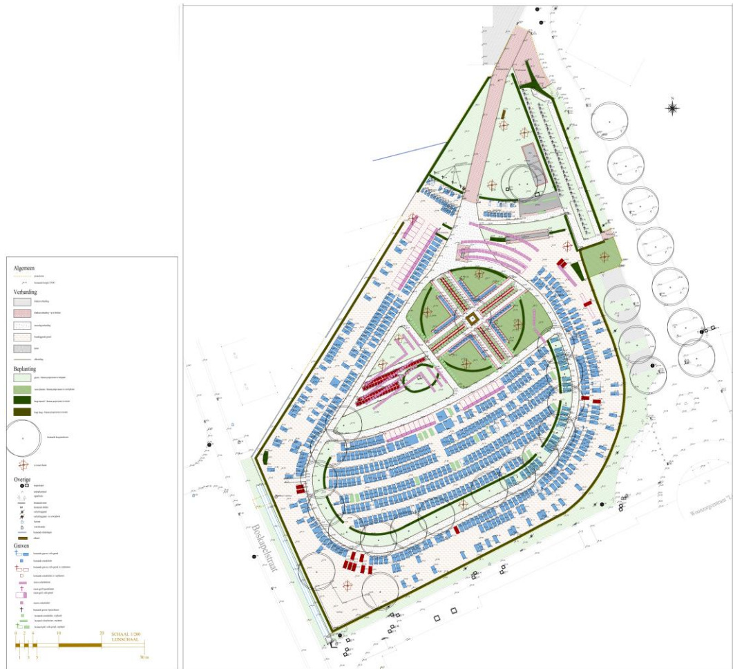
Afb. 12. Een schematisch plan dat overlap toont tussen de huidige en geplande toestand. De rood aangegeven elementen dienen te verdwijnen door de nieuwe plannen. De roos aangegeven elementen zijn nieuwe toevoegingen binnen de huidige werken (Bron: Opdrachtgever)
