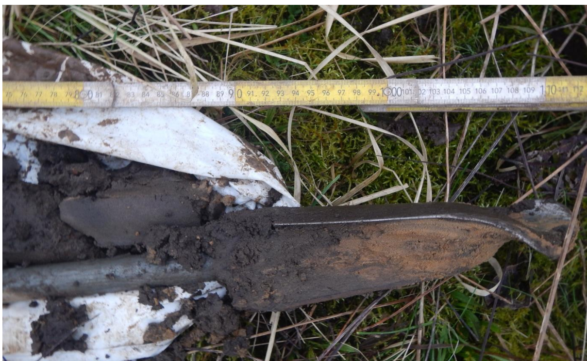
Figuur 35 Detail boring 4 met scherpe overgang naar het moedermateriaal.
