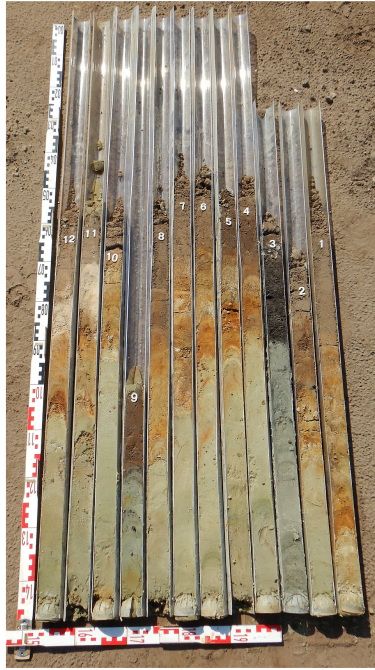
Figuur 6. Sedimenten, opgeboord met een geoprobe. De bodemvorming in de sedimenten is in een lage resolutie leesbaar, maar slappe sedimenten zijn gecompacteerd.
