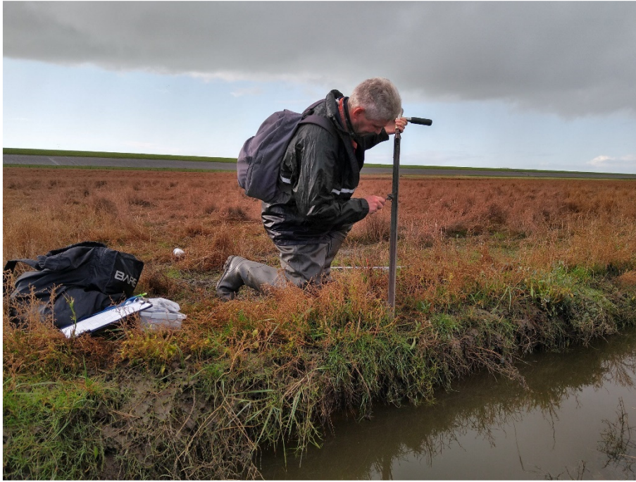
Figuur 5. Sedimenten, opgeboord met een gutsboor. Het gaat om slappe, jonge sedimenten. De bodemvorming in de sedimenten is in een hoge resolutie leesbaar.
