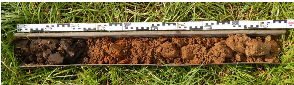
Figuur 4. Sedimenten, opgeboord met een edelmanboor, uitgelegd op een kunststof liner. De bodenvorming in de sedimenten is in een lage resolutie leesbaar.
