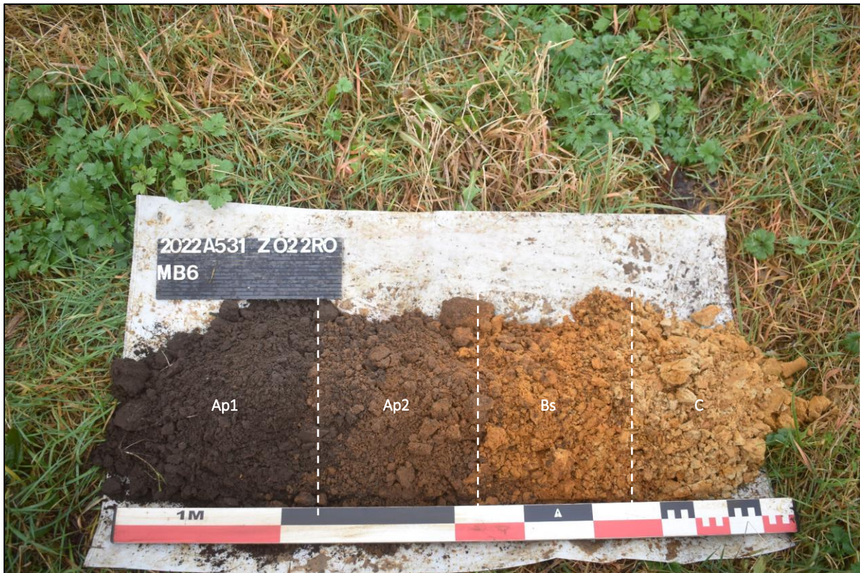
Afb.22: Referentieprofiel MB6 met aanduiding van bodemhorizonten Ap1 – Ap2 – Bs – C. (Bron: Aron bv)
