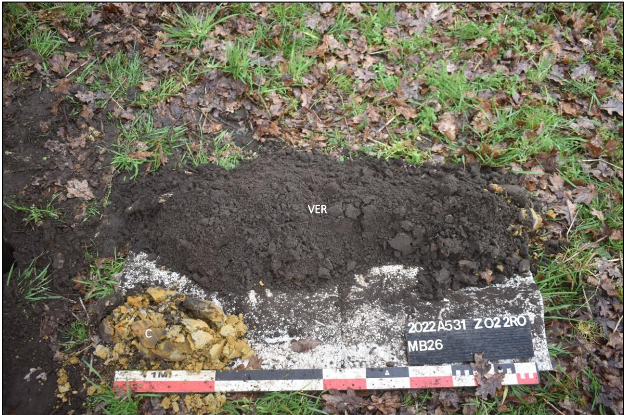
Afb.24: Referentieprofiel MB26 met aanduiding van bodemhorizonten VER – C. (Bron: Aron bv)
