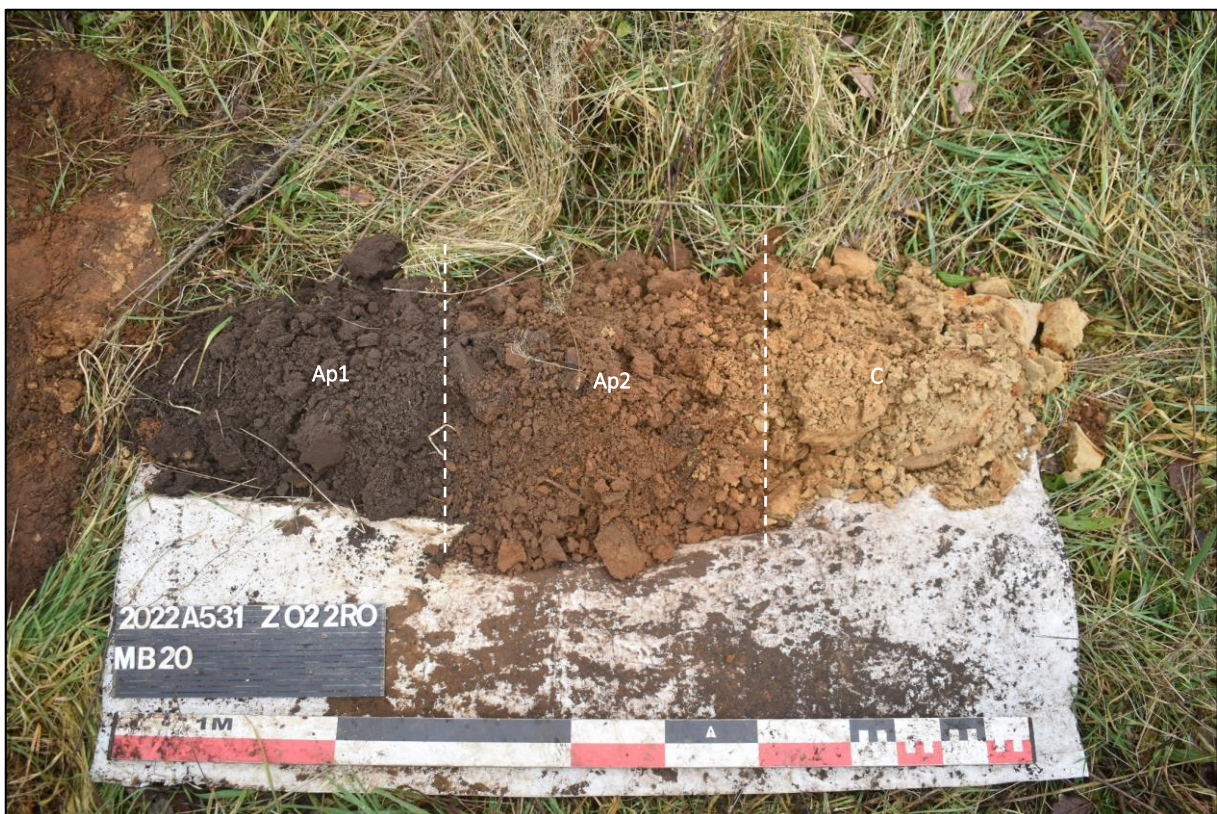
Afb.23: Referentieprofiel MB20 met aanduiding van bodemhorizonten Ap1 – Ap2 – C. (Bron: Aron bv)
