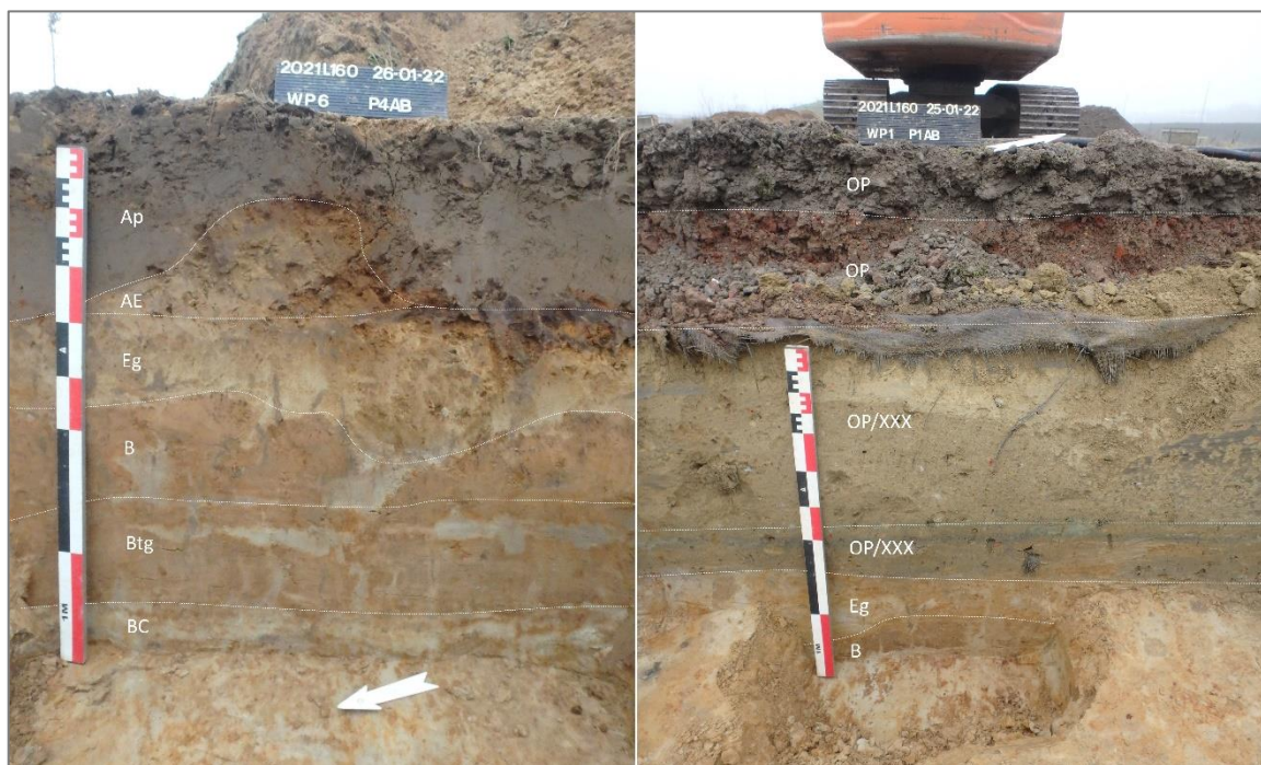
Figuur 15: Links: Profiel P4AB met een relatief intact profiel. Rechts: Profiel P1AB is onthoofd tot in de uitlogingshorizont.
