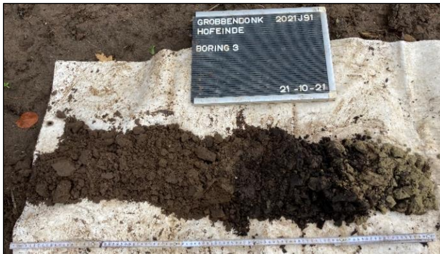
Figuur 14: Boorprofiel van boring 3. (ABO nv 2021)
