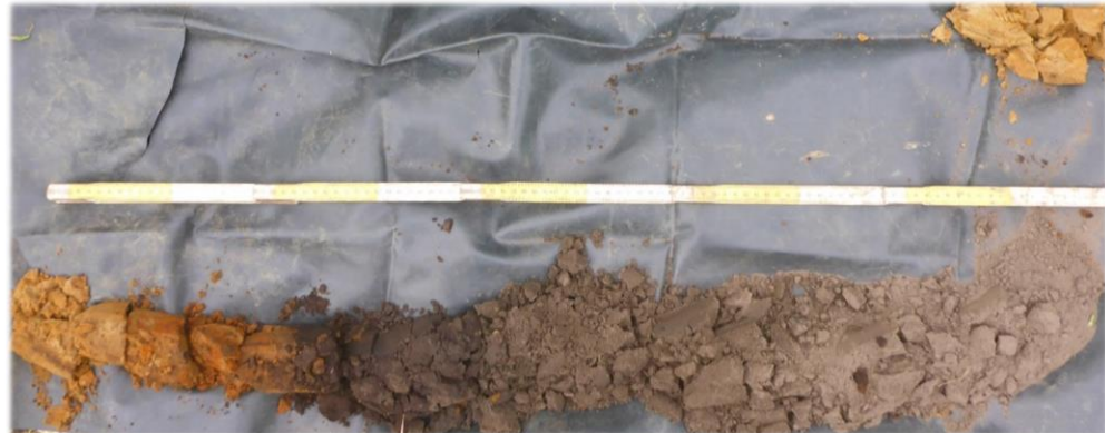
Figuur 3: Boring10 toont een diepe ploeglaag [0-60 cm], op een Bh-horizont [80-120 cm] ontwikkeld in eolisch zand.
