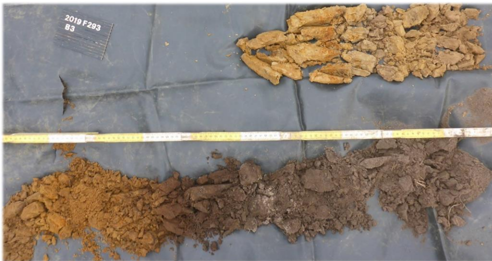
Figuur 5: Boring 3 toont de superpositie van teelaarde [0-45 cm] op de opeenvolging van een E-, Bh-, Bs- en C-horizont [45-114 cm]; Hier is tussen 114 en 121 cm een A-horizont geregistreerd en vanaf 121 cm fluviatiel zand
