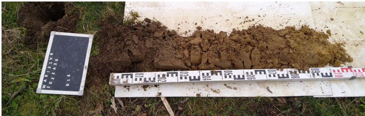
Figuur 5: Voorbeeld van een geregistreerde boring (B18) op het terrein.
