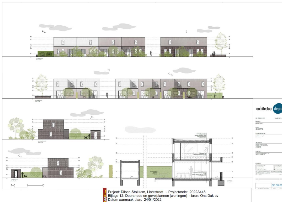
Fig. 19: Doorsnede en gevelplannen (woningen)
