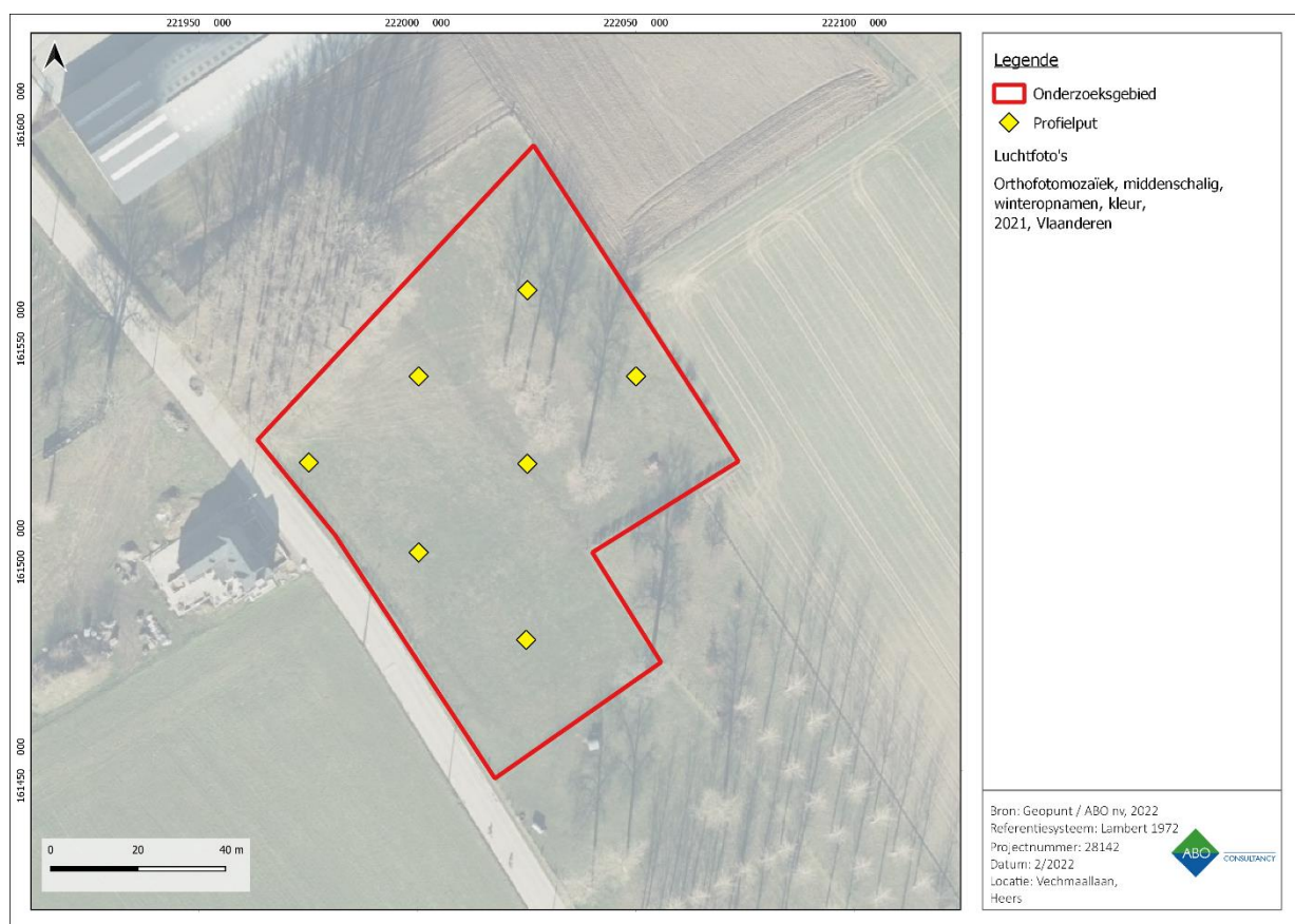
Figuur 3: Luchtfoto 2021 met de inplanting van de landschappelijke profielputten binnen het terrein voor grondverbetering en bufferbekken.
