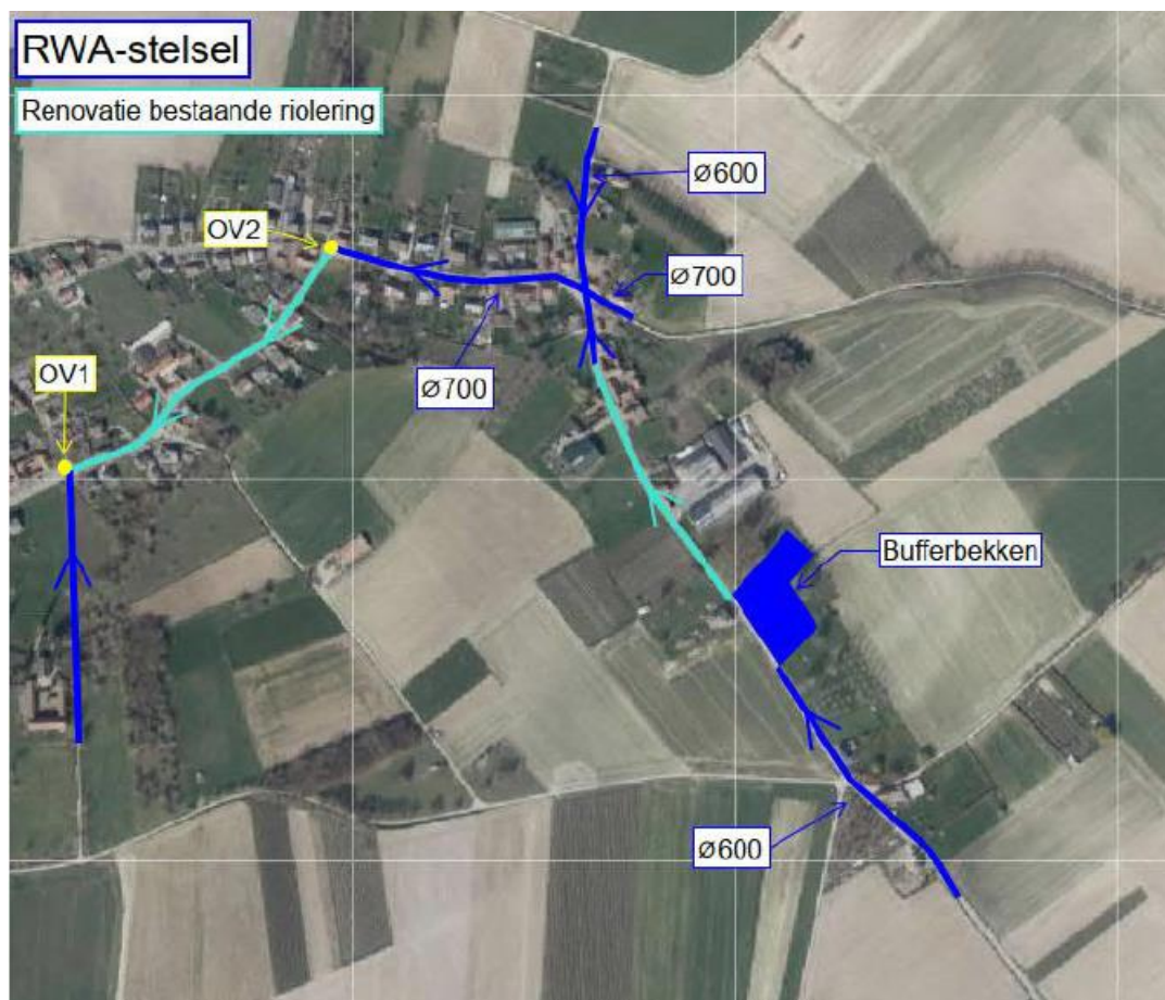
Figuur 6: Overzicht van RWA-stelsel deelproject 20.545V (Initiatiefnemer 2022).
