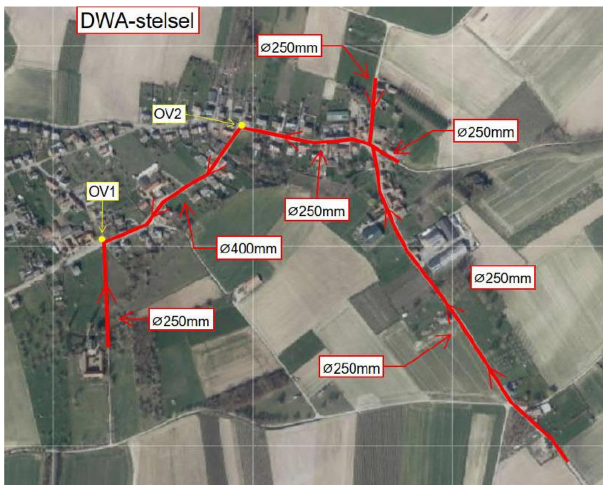
Figuur 4: Overzicht van DWA-stelsel deelproject 20.545V (Initiatiefnemer 2022).
