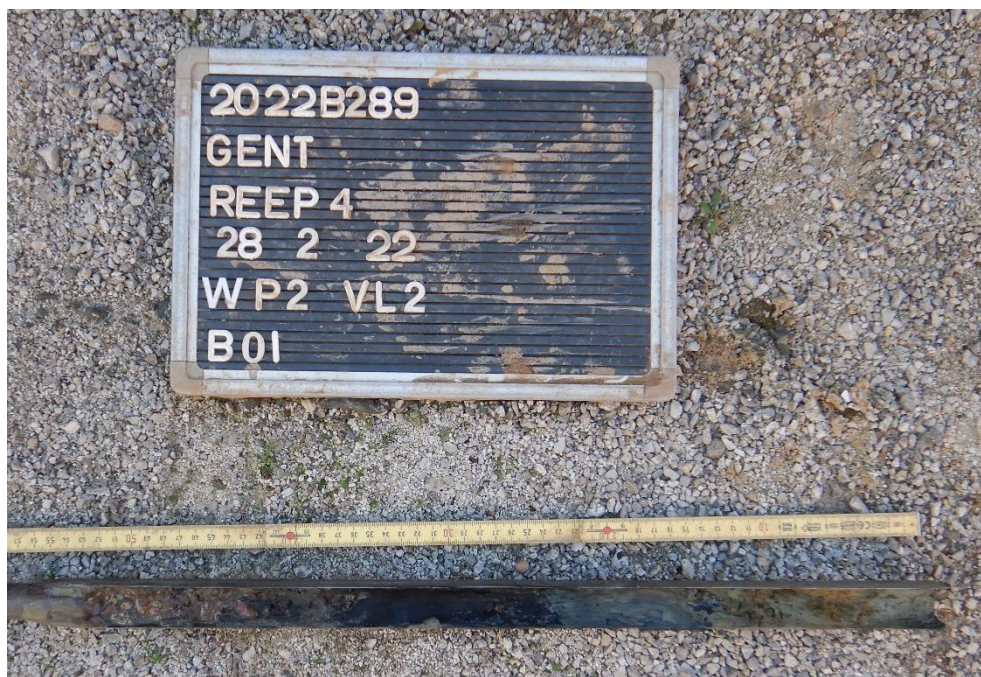
Figuur 20: Werkput 2, humeuze laag in boring 1 op een diepte van 4,2 m onder het maaiveld
