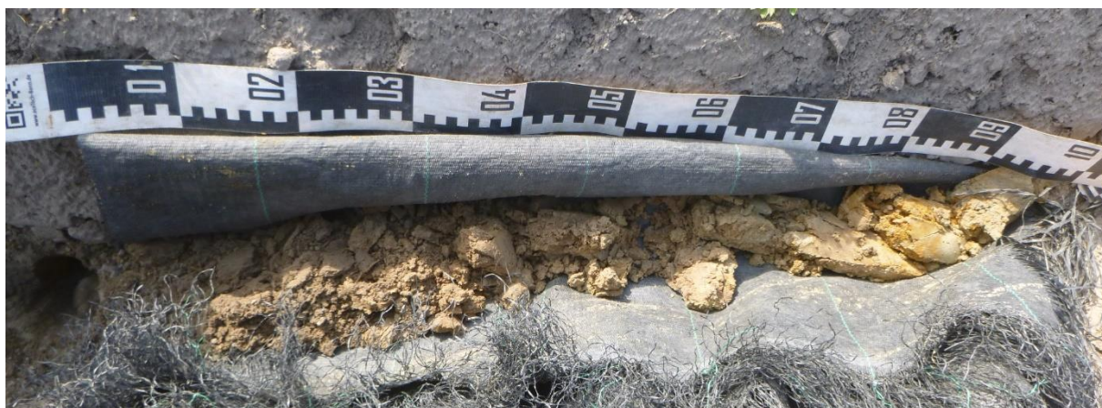
Figuur 20: Overzichtsfoto van boring BP15, uitgelegd van links naar rechts.
