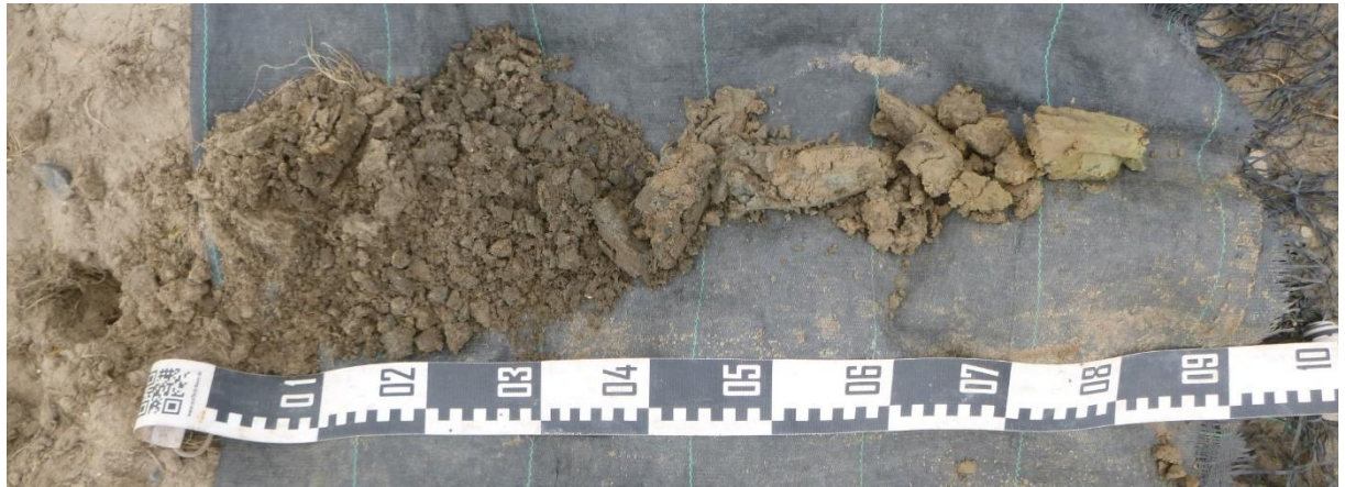
Figuur 23: Overzichtsfoto van boring BP10, uitgelegd van links naar rechts.
