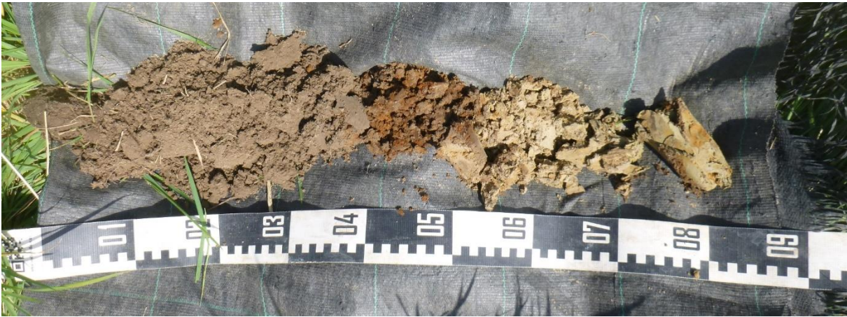
Figuur 21: Overzichtsfoto van boring BP2, uitgelegd van links naar rechts.
