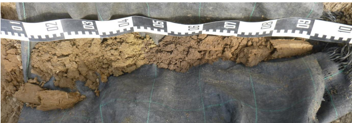
Figuur 22: Overzichtsfoto van boring BP8, uitgelegd van links naar rechts.
