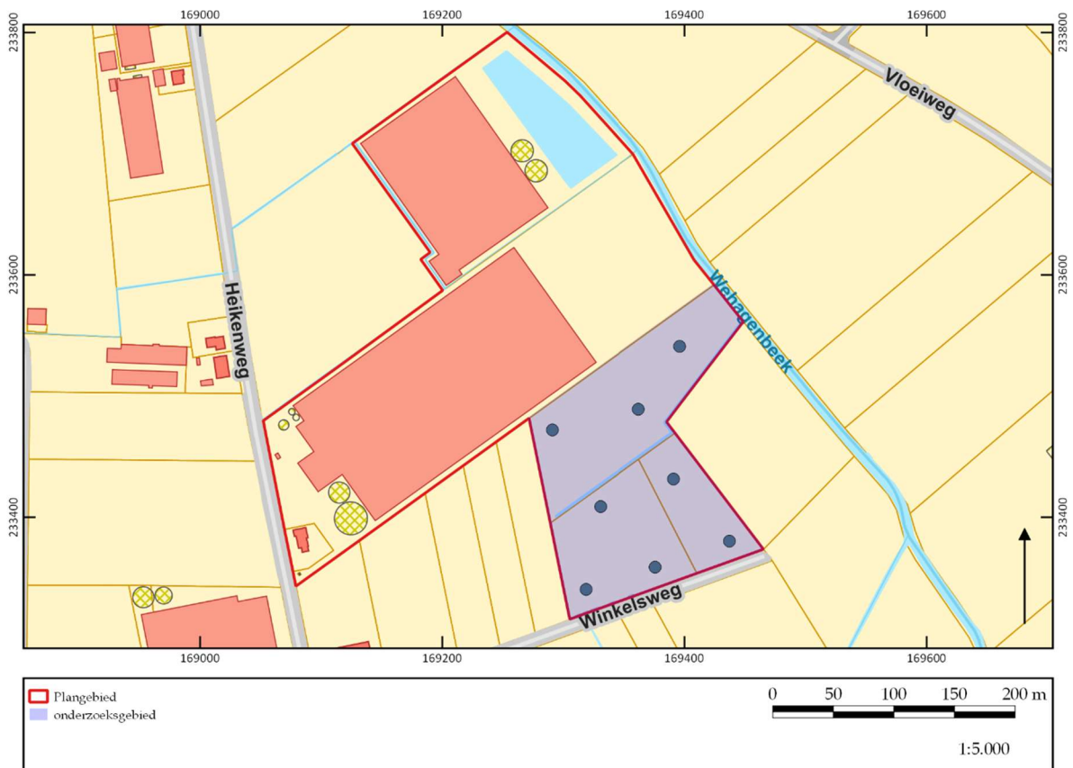
Figuur 6. Voorstel voor de boorlocaties in functie van het landschappelijk bodemonderzoek.
