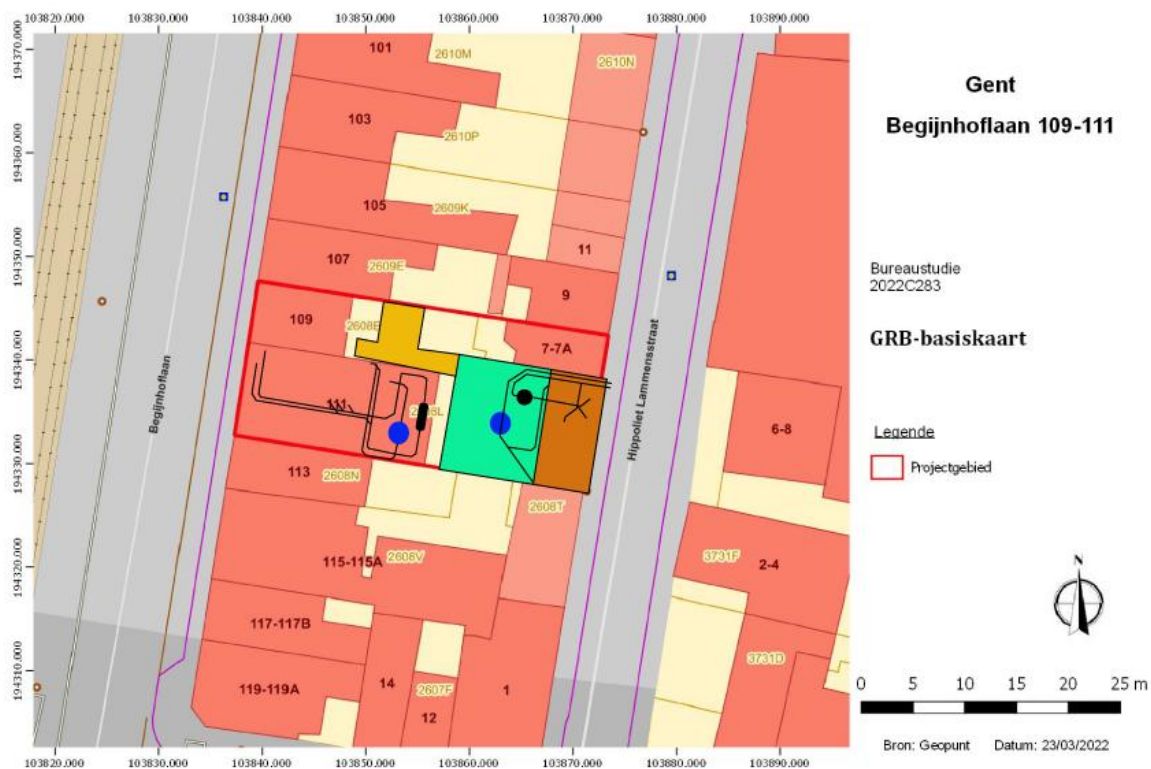
Figuur 1 Vereenvoudigde weergave van de geplande werken op GRB-basiskaart. Legende: Oranje: vloerplaat Geel: fietsenstalling, blauw: waterput, groen: afgraven tuin, zwart: septische put en nutsleidingen. (bron: geopunt)
