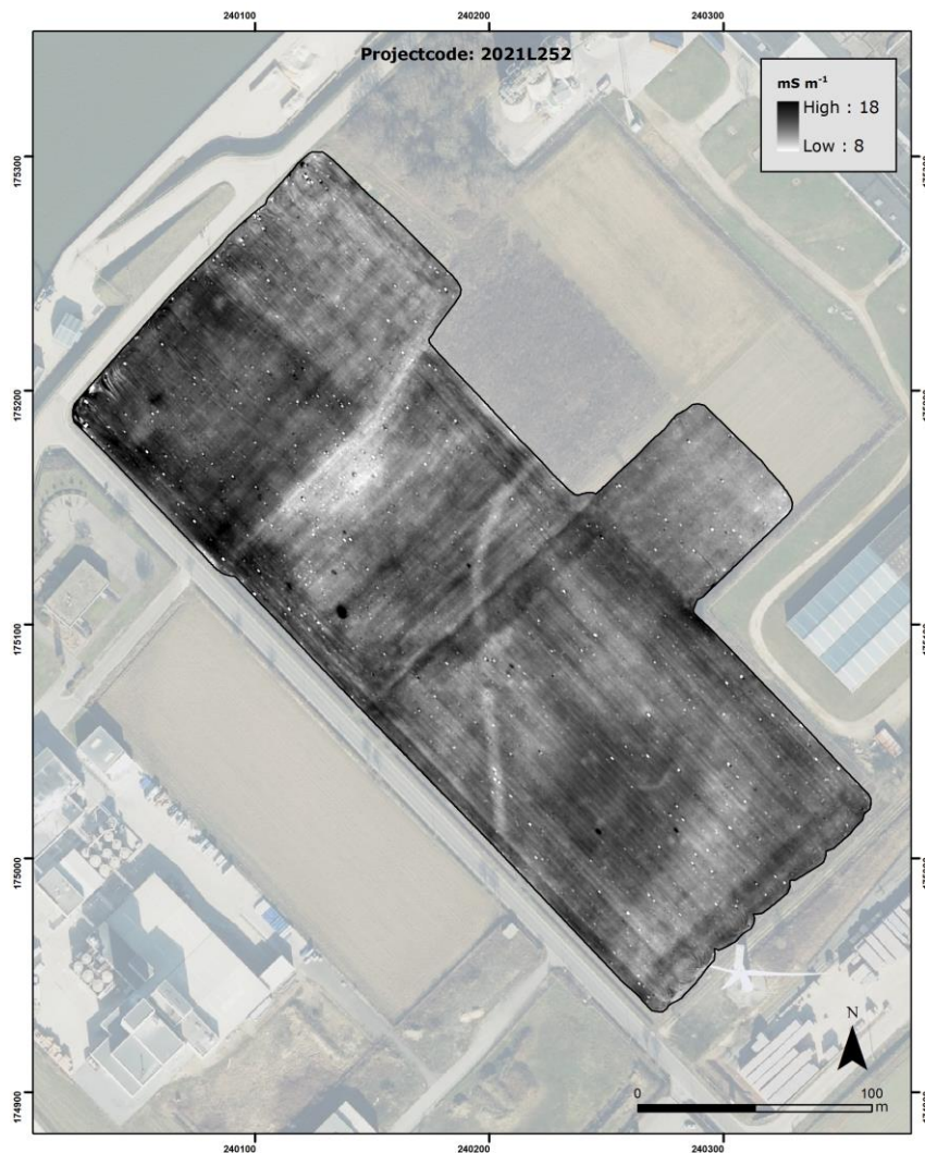
Figuur 6: EG opgemeten met de 1PRP spoelconfiguratie (dominante respons tussen 0 en 0.5 m diepte).
