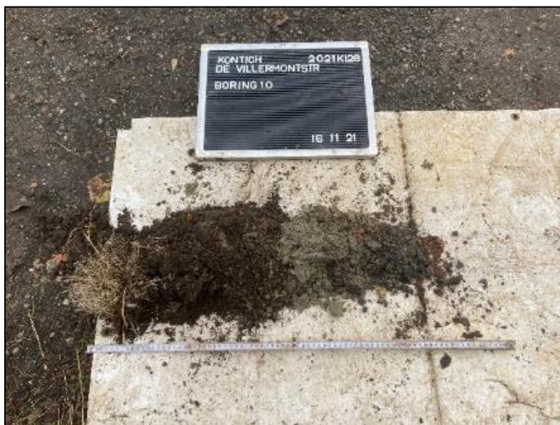
Figuur 12: Foto's van bodemopbouw ter hoogte van boring 10 (links westzijde en rechts oostzijde van put)
